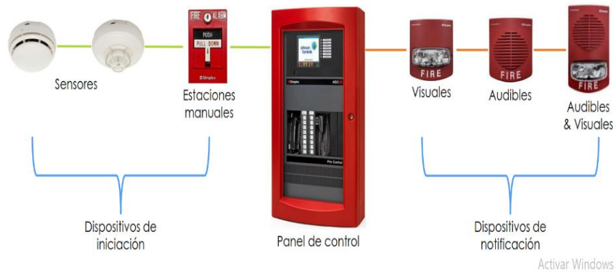
Figura 5: Sistema de detección y alarma contra incendios [13]
