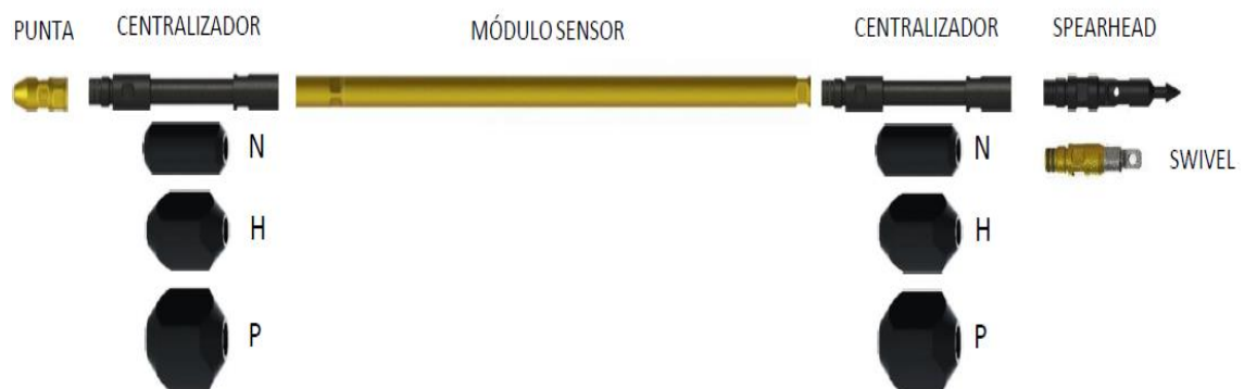
Figura 2. Configuración de toolstring de la herramienta
