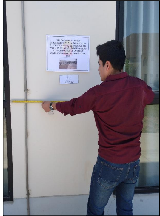
Verificación de medidas de la columna C-1 tipo rectangular (1er piso) del pabellón de la facultad de Derecho y Ciencia Política de la ciudad universitaria, San Luis Gonzaga. Fuente: Propia
