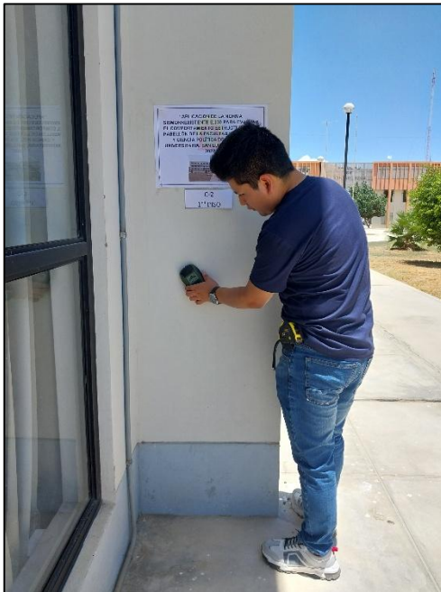
Verificación de elementos de concreto armado C-2 del pabellón de la facultad de Derecho y Ciencia Política de la ciudad universitaria, San Luis Gonzaga.
