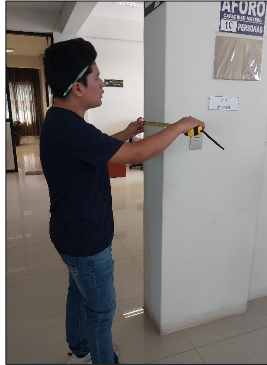
Verificación de medidas de la columna C-14 Y C-4 (3er piso) del pabellón de la facultad de Derecho y Ciencia Política de la ciudad universitaria, San Luis Gonzaga.
