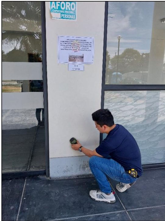
Verificación de elementos de concreto armado C-4 del pabellón de la facultad de Derecho y Ciencia Política de la ciudad universitaria, San Luis Gonzaga. Fuente: Propia
