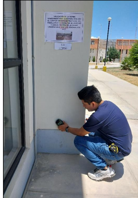
Verificación de elementos de concreto armado C-2 del pabellón de la facultad de Derecho y Ciencia Política de la ciudad universitaria, San Luis Gonzaga.
