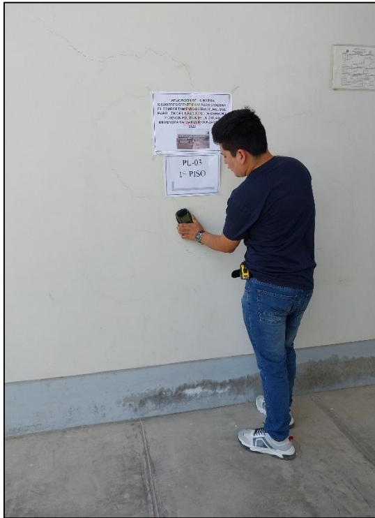
Verificación de elementos de concreto armado PL-03 del pabellón de la facultad de Derecho y Ciencia Política de la ciudad universitaria, San Luis Gonzaga.
