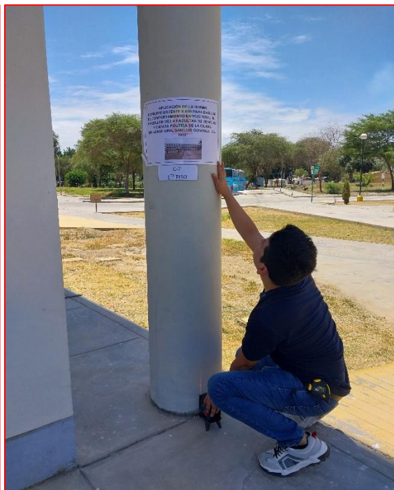
También se verificó el alineamiento vertical de los elementos estructurales con el equipo de nivel de láser.
