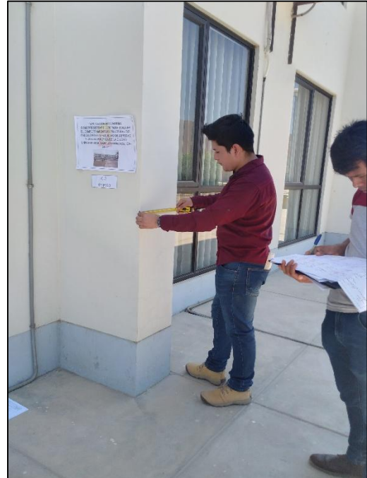
Verificación de dimensiones de la columna C-2 Tipo "T" (1er piso) del pabellón de la facultad de Derecho y Ciencia Política de la ciudad universitaria, San Luis Gonzaga. Fuente: Propia
