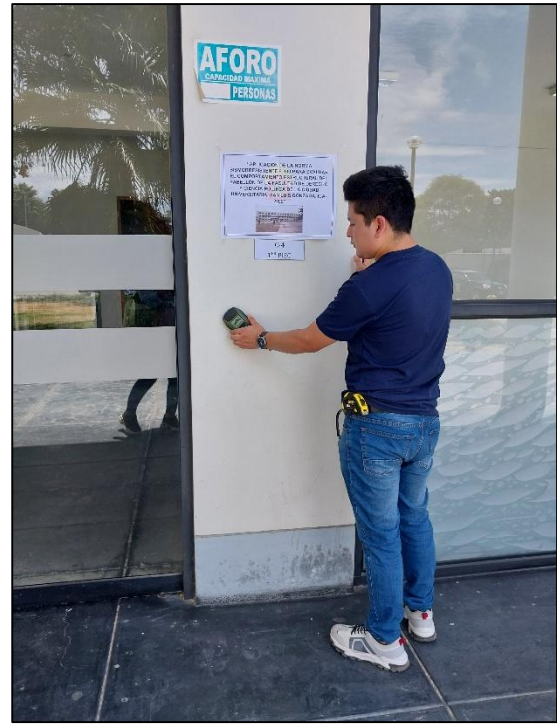
Verificación de elementos de concreto armado C-4 del pabellón de la facultad de Derecho y Ciencia Política de la ciudad universitaria, San Luis Gonzaga. Fuente: Propia
