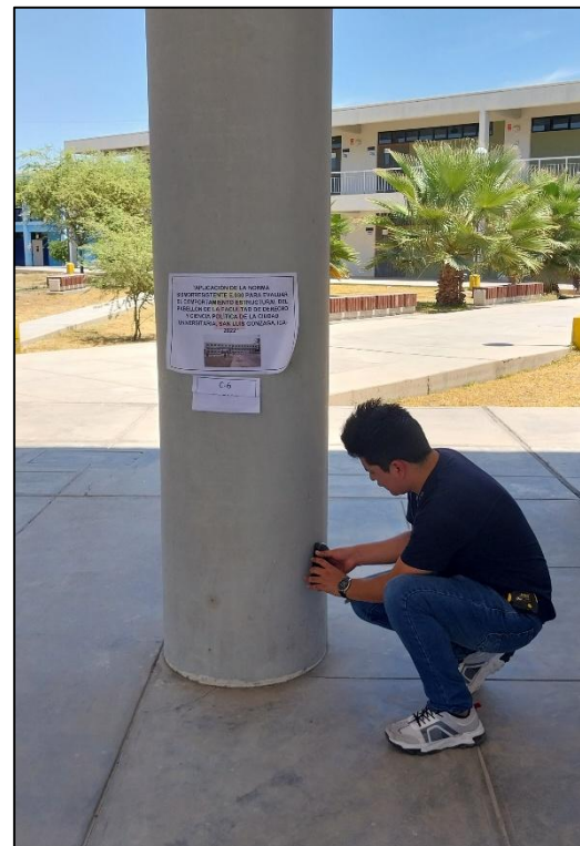
Verificación de elementos de concreto armado C-6 del pabellón de la facultad de Derecho y Ciencia Política de la ciudad universitaria, San Luis Gonzaga. Fuente: Propia
