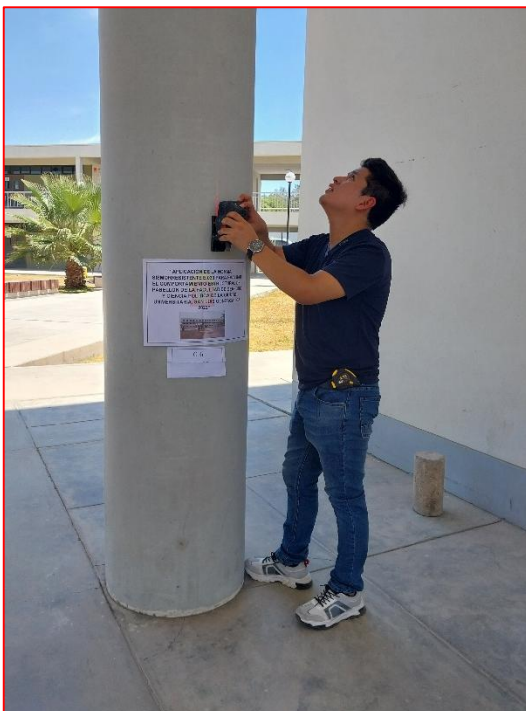
También se verificó el alineamiento vertical de los elementos estructurales con el equipo de nivel de láser.
