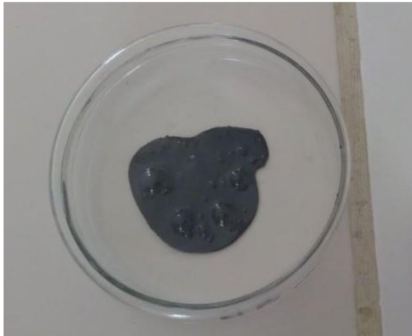
Figura 16. Determinación de Sólidos Totales del extracto etanólico de las partes aéreas de Heliotropium Curassavicum “hierba del alacrán”.
