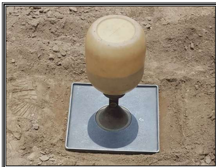
FOTOGRAFÍA N°08: SE OBSERVA EL ENSAYO DEL CONO DE ARENA EN UNA DE LAS GRADAS DE LA CALICATA DEL PROYECTO.
