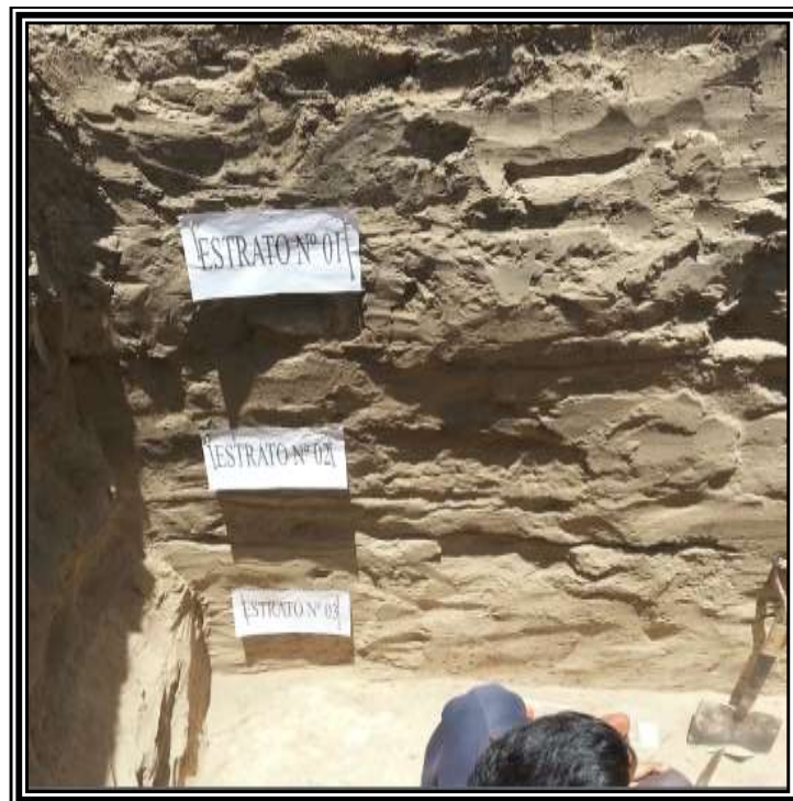
FOTOGRAFIA N°6: IDENTIFICACION DE CADA UNO DE LOS ESTRATOS QUE POSEE LAS 3 CALICATAS REALIZADAS.
