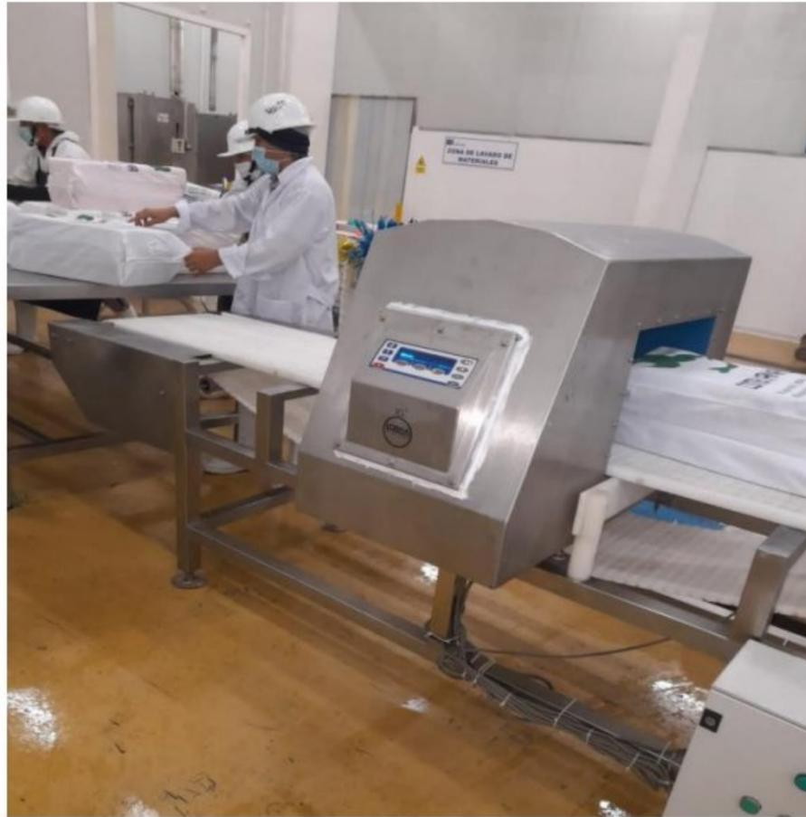
**figura 17: Maquina detectora de metales de la planta pesquera Exalmar S.A.A.
