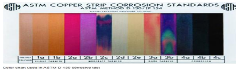
Figura 11. Colorimétrico de corrosión de la tubería de cobre.
