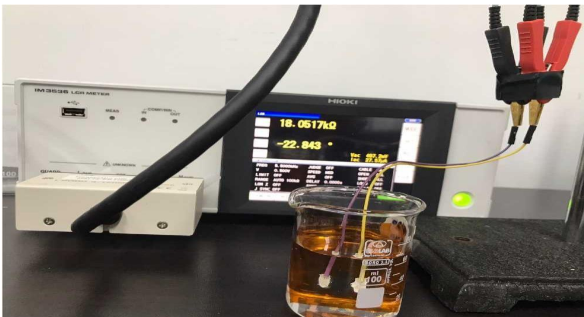
Figura 6.5: Sensor Capacitivo interdigital basado en grafeno conectado al medidor LCR.
