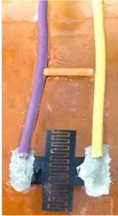
Figura 6.3: Prototipo de capacitor interdigital fabricado en grafeno inducido sobre poliamida.
