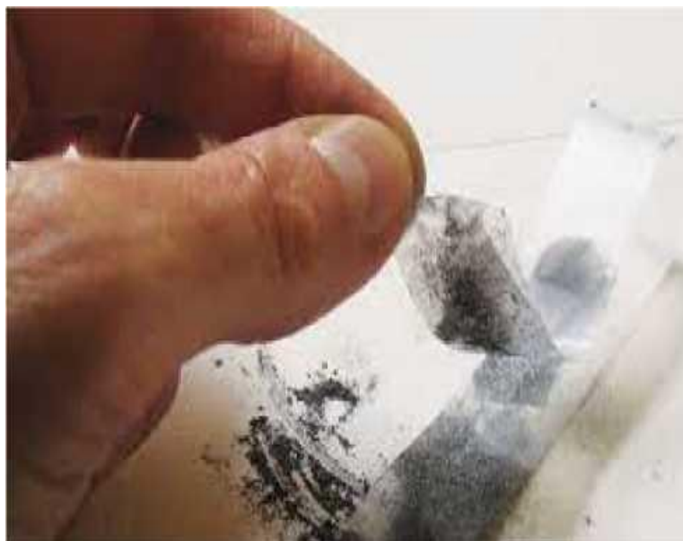
Figura 1.5: Obtención de grafeno por exfoliación mecánica con cinta adhesiva.
