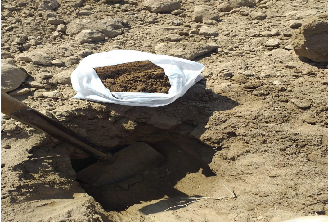
Figura 4: Calicata para la toma de muestra de suelo
