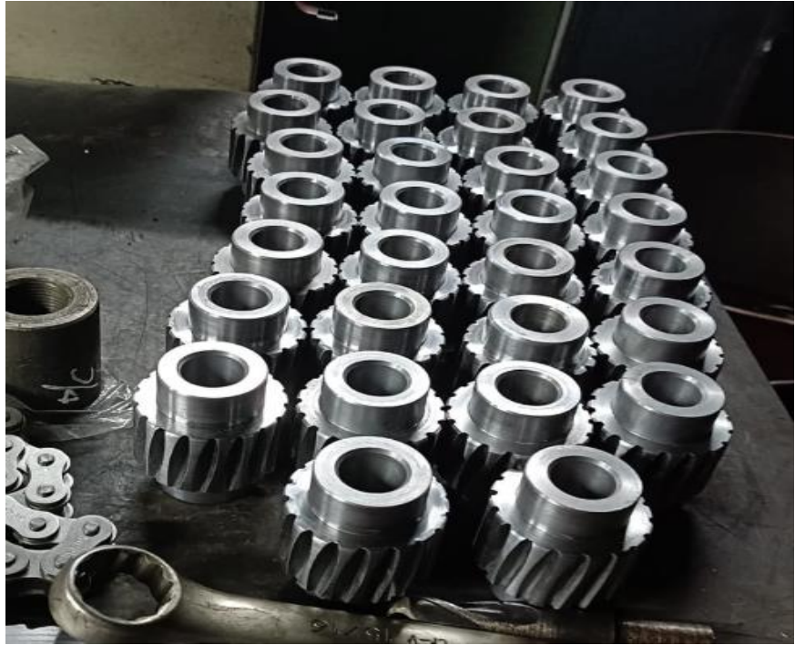
Fig. 20 Fabricación final de piñones
