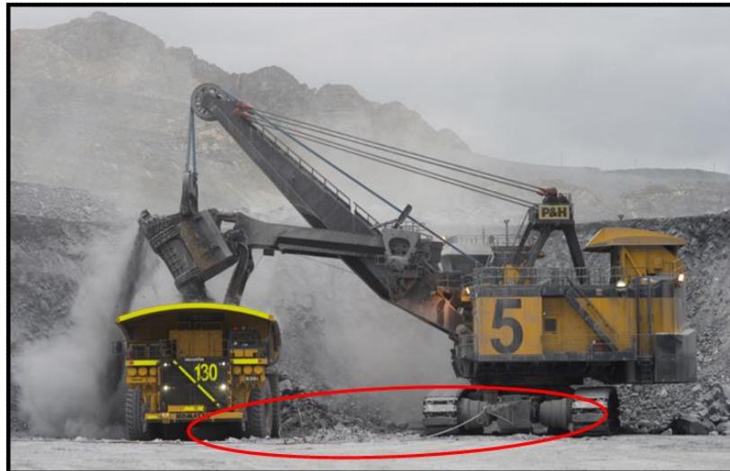
Fig. 3 Carguío de mineral mediante pala eléctrica con cable de arrastre
