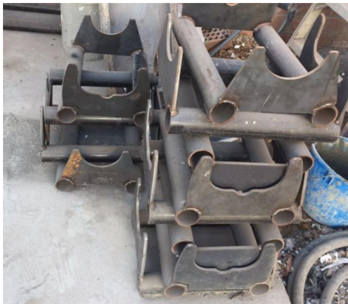
Fig. 17 Habilitado de conector extendido para skit
