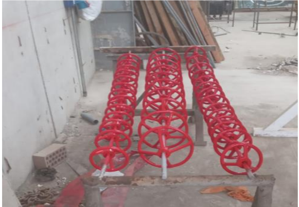
Fig. 32 Fabricación en lote de timones para skit
