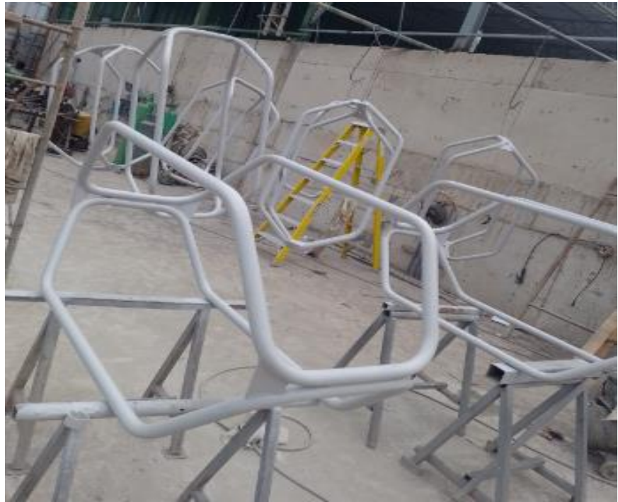
Fig. 21 Proceso de pintado de estructura de skit
