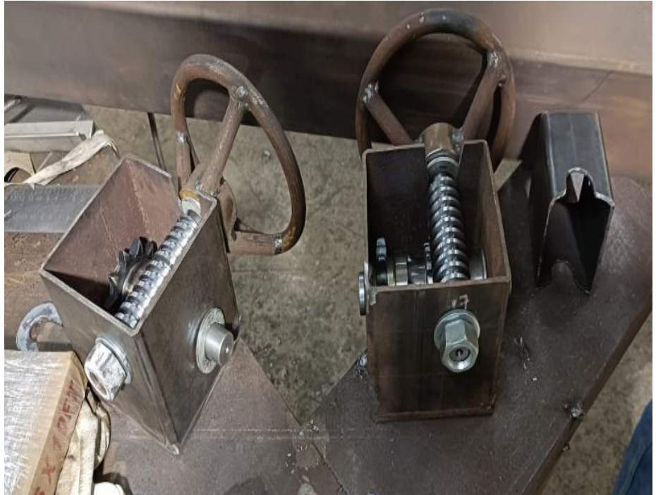
Fig. 28 Armado de caja porta mecanismo y timón
