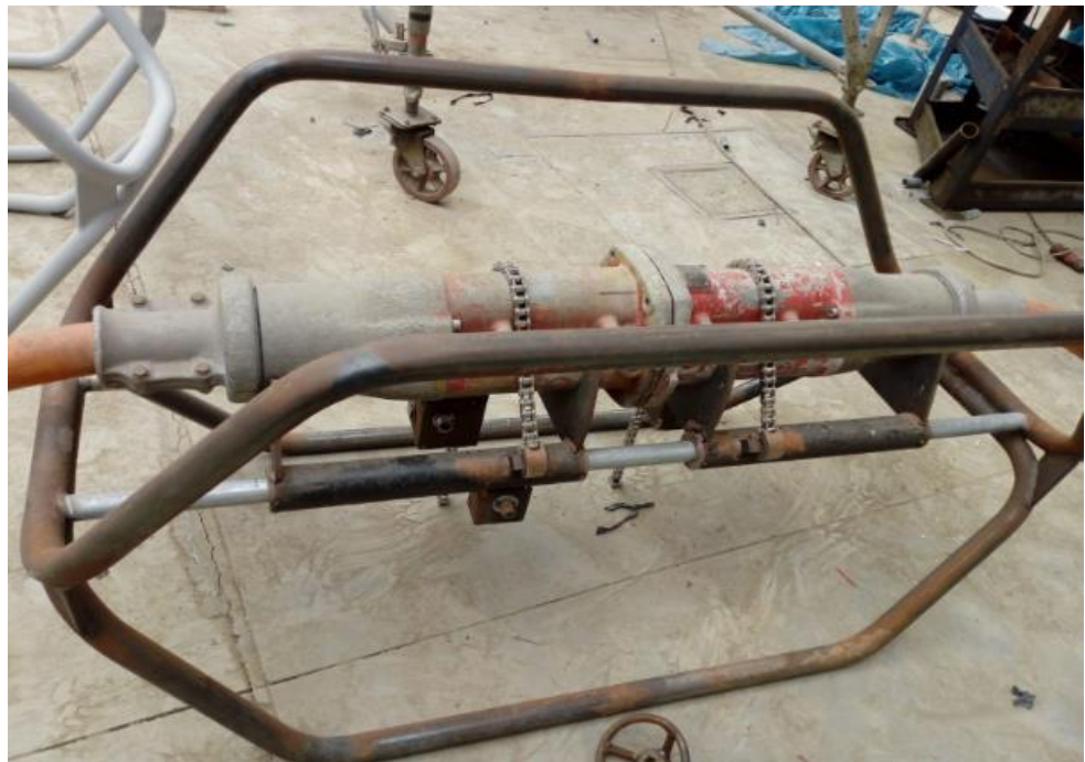
Fig. 31 Ensamblaje final de prototipo de skit modelo SFM 5.0-23
