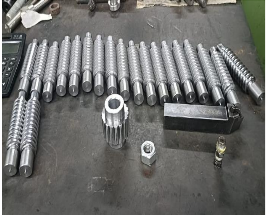
Fig. 22 Fabricación de tornillo sin fin
