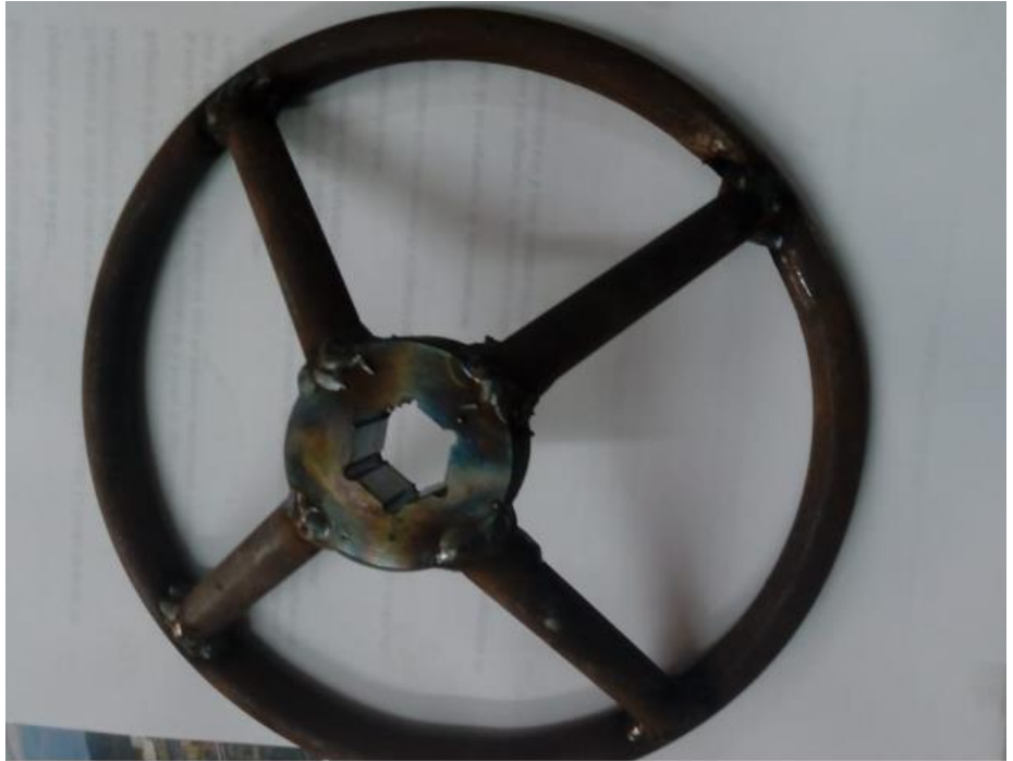
Fig. 26 Fabricación de timón con hexagonal soldado
