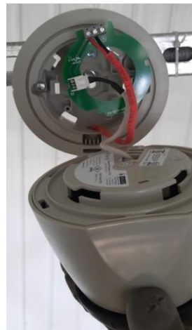
Fig. 629: Conexión de cables IDC hacia el controlador
