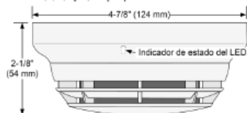
Sensor de ionización 4098-9717 con base
