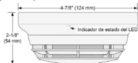
Sensor fotoeléctrico 4098-9714 con base
