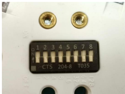
Fig. 1040: Dip Switch de 8 posiciones de detector de humo
