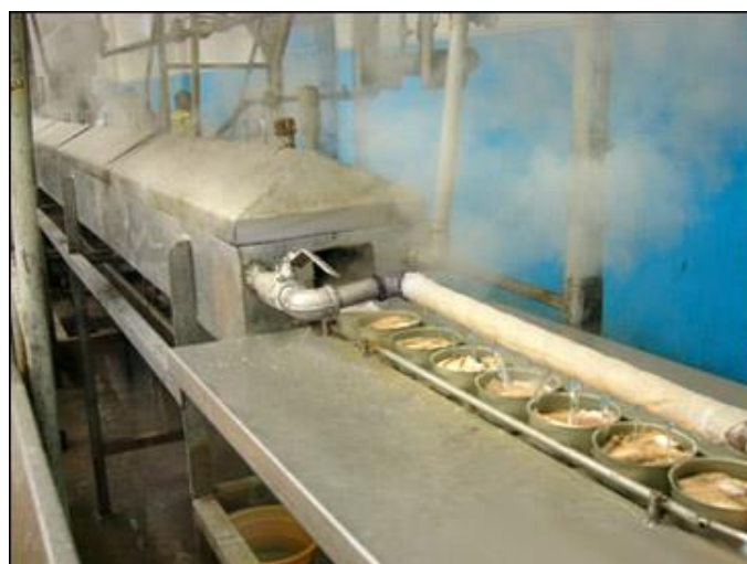
Figura 13. Exhausting de conservas por vapor Fuente: Extraído de https://www.donfernandosac.pe/images/proc_09A.jpg
