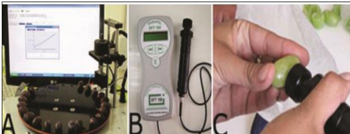
Figura 15. Escala Instrumentos para la determinación de firmeza en uva de mesa. A y B) FirmtechII y C) Durofel.
