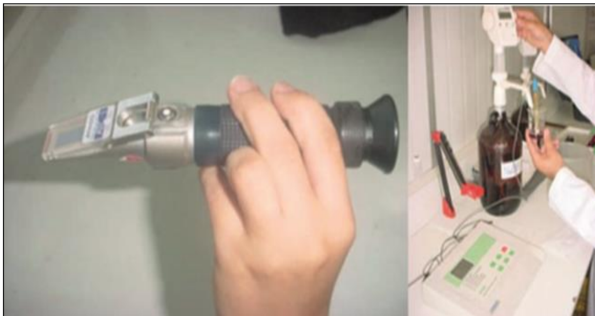
Figura 7. Instrumentos para medición de sólidos solubles totales (refractómetro a la izquierda) y acidez titulable (potenciómetro a la derecha).
