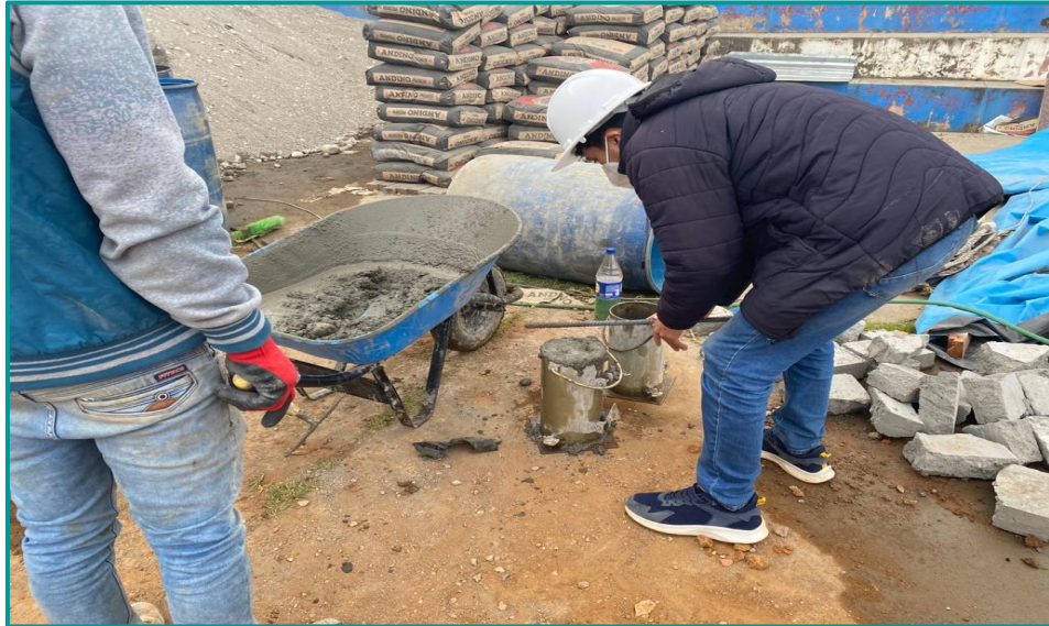
Fig. 53. Indicaciones para chuceo o vibración para el ensayo de probeta
