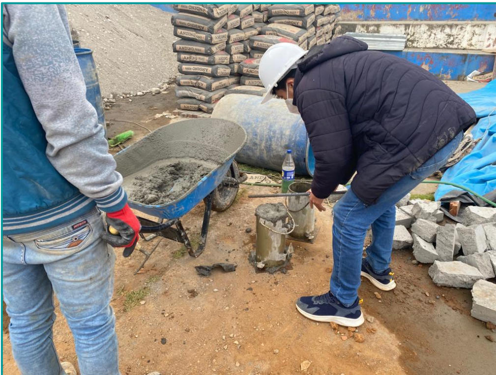
Obtención de probetas para ensayos de laboratorio
