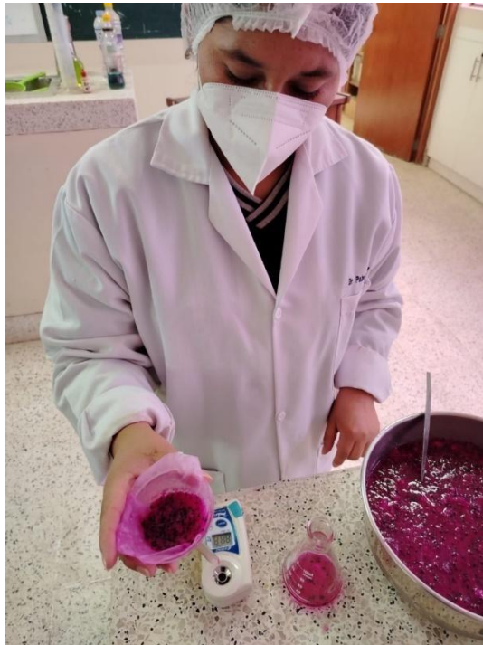
Medición de grados brix en el zumo recientemente obtenido
