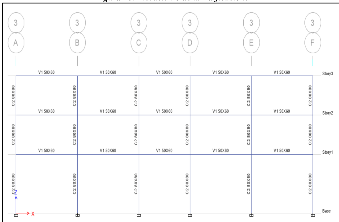
Figura 18. Elevación 3 de la Edificación.
