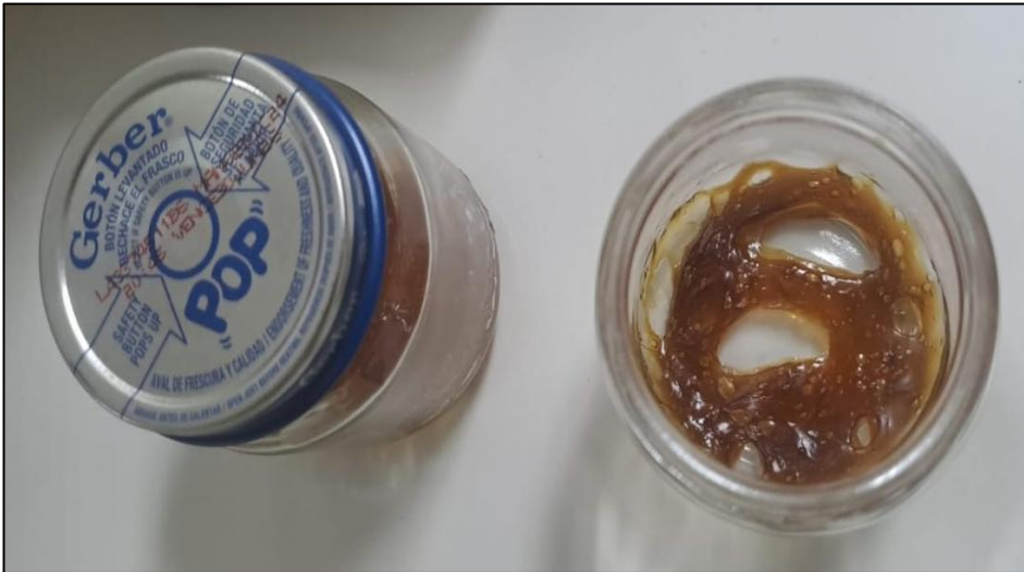
Estado de gel al día 15, en frasco con tapa y sin tapa en ensayo ciclos de temperaturas
