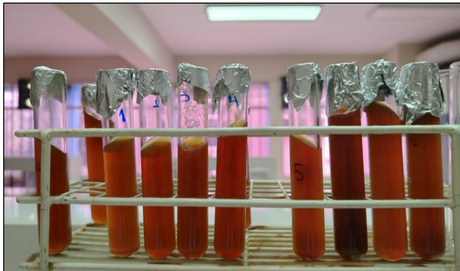
Homogeneidad de la muestra en frascos tapados en el transcurso de 15 días
