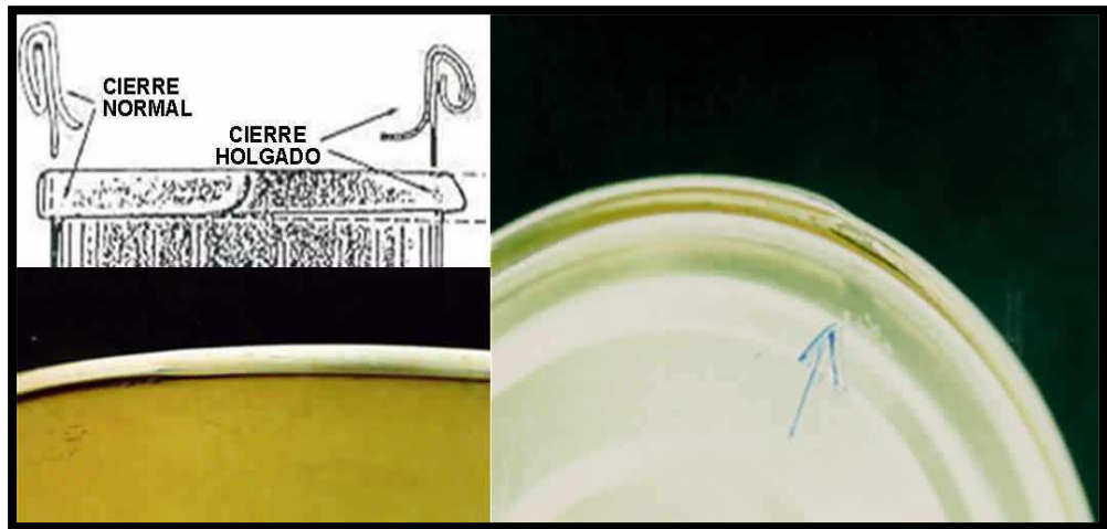
Ilustración 20: Defectos apreciables visualmente: Spinner. (Canadian Food Inspection Agency)
