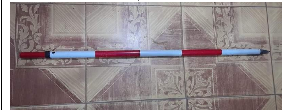
Foto 02: Jalón de un metro de metal
