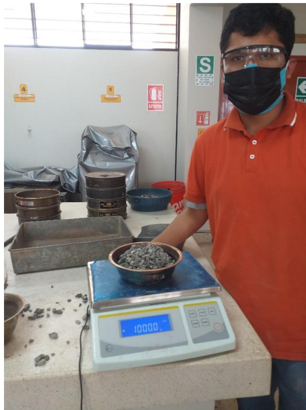
Fig. 50. Peso de agregado grueso Fuente: Laboratorio de Mecánica de Suelos de la Facultad de Ingeniería Civil
