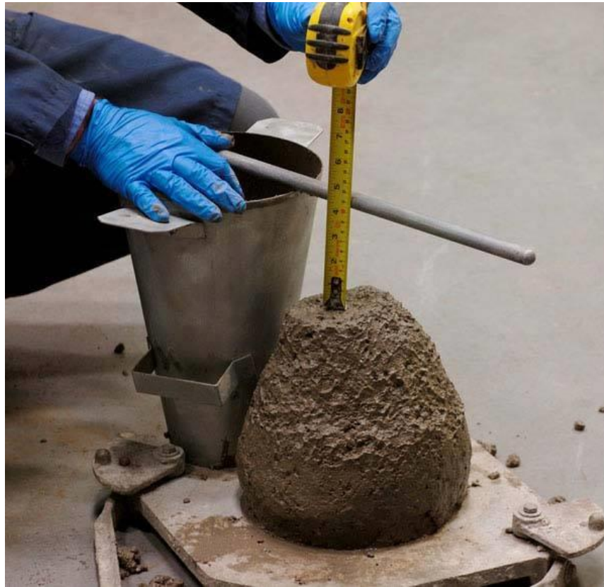
Fig. 4. Ensayo de asentamiento o slump
