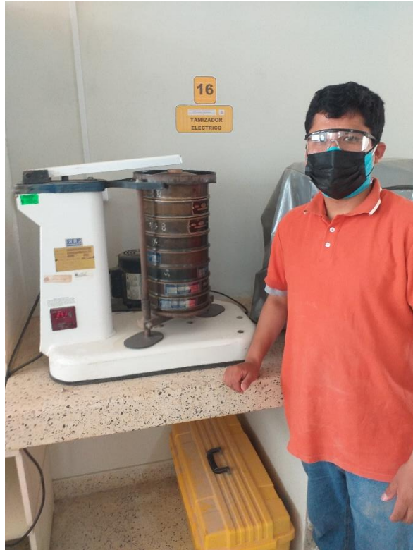
Fig. 53. Ensayo granulométrico de agregados Fuente: Laboratorio de Mecánica de Suelos de la Facultad de Ingeniería Civil
