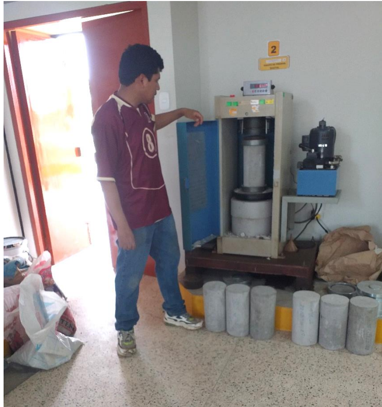
Fig. 57. Rotura de Probetas en el Laboratorio Fuente: Laboratorio de Mecánica de Suelos de la Facultad de Ingeniería Civil
