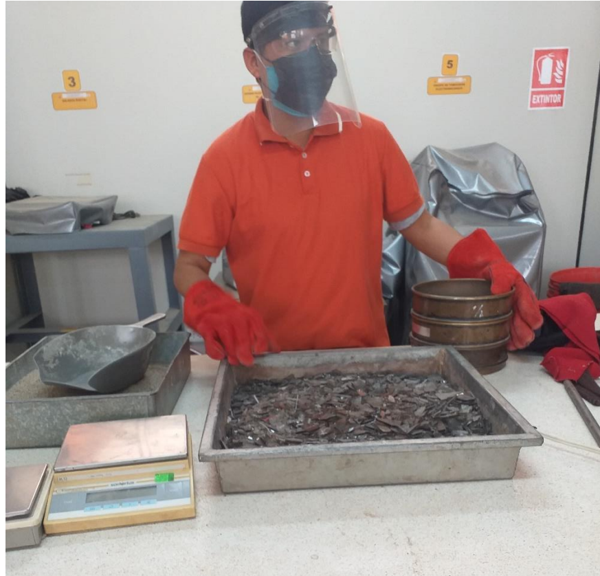
Fig. 55. Vidrio reciclado triturado en reemplazo de agregado grueso Fuente: Laboratorio de Mecánica de Suelos de la Facultad de Ingeniería Civil
