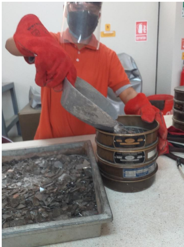
Fig. 56. Tamizado de Vidrio reciclado triturado Fuente: Laboratorio de Mecánica de Suelos de la Facultad de Ingeniería Civil
