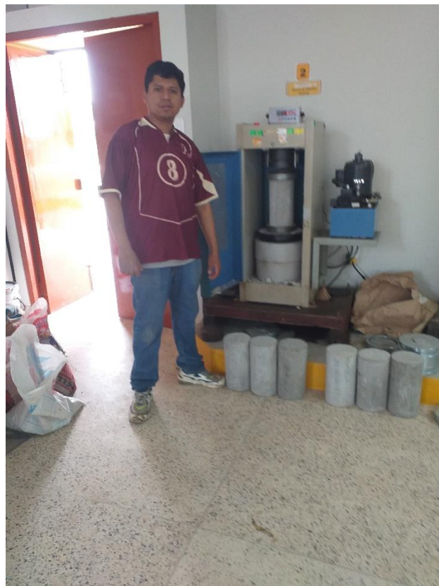
Fig. 58. Rotura de Probetas en el Laboratorio Fuente: Laboratorio de Mecánica de Suelos de la Facultad de Ingeniería Civil
