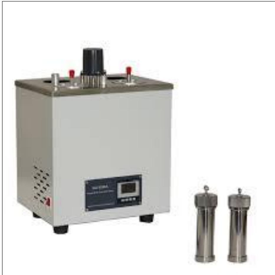
Figura 9. Equipo empleado en el ensayo de corrosión en lámina de cobre.
