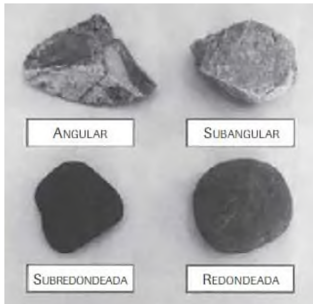
Figura 2 Forma de las partículas de suelos gruesos
