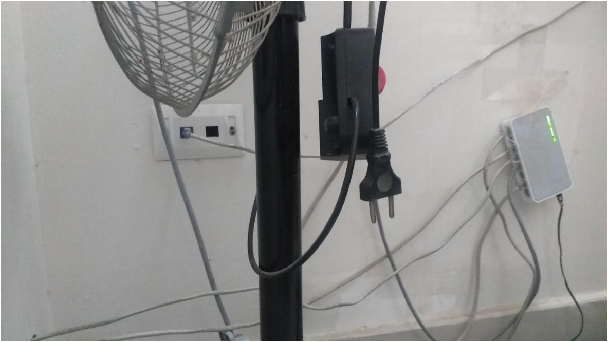
Fig. 21. Improvisación de switch
