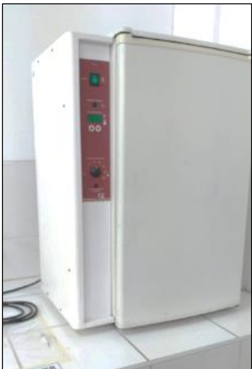
Figura 3.44. Incubadora, con la cual se mide el valor del DBO 5 .
