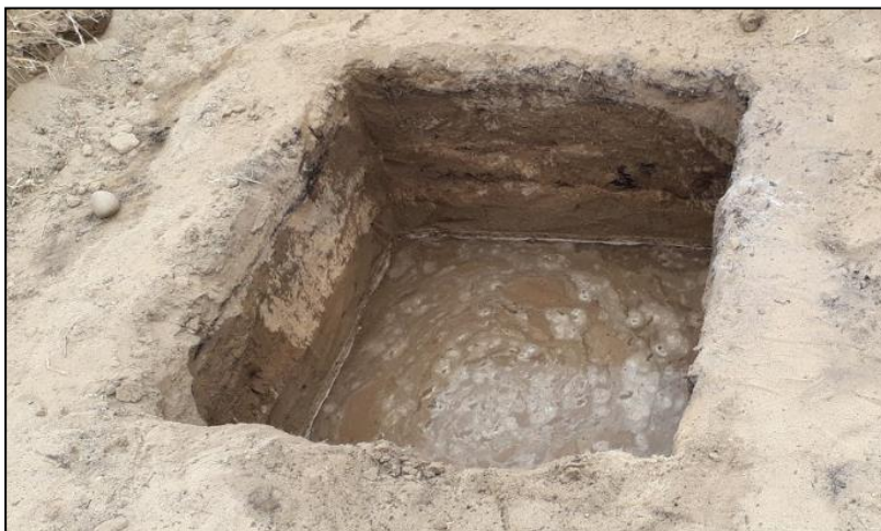
Figura 3.12. Pozo excavado a cierta profundidad, humedecido todo el contorno
