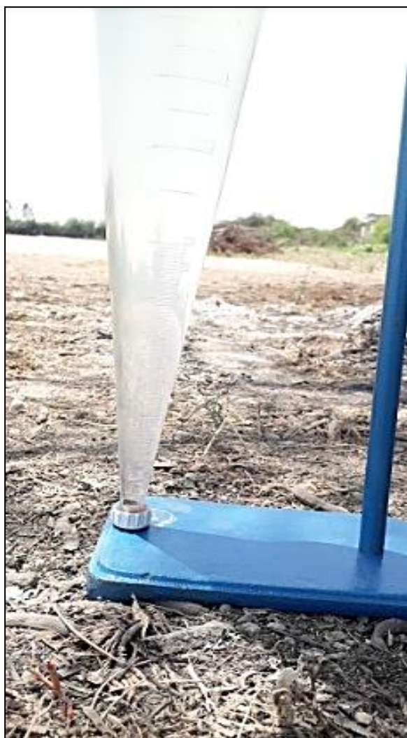
Figura 3.37. Medición de los sólidos sedimentables (SS), mediante un cono Imhoff
