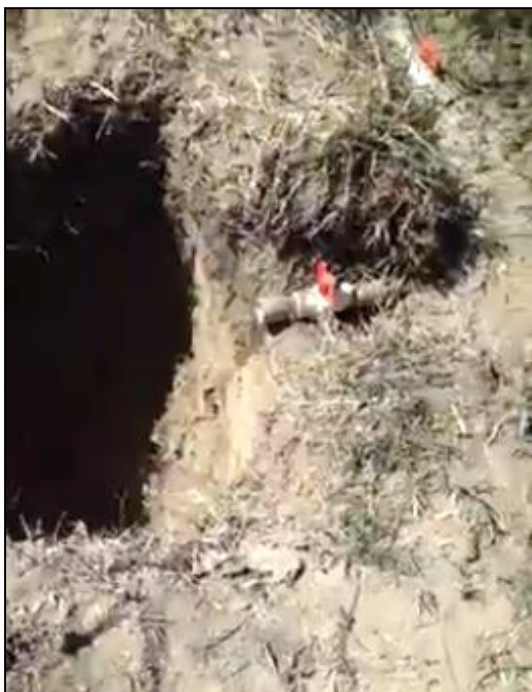
Figura 3.21. Agujero (espacio), para la medición del caudal
