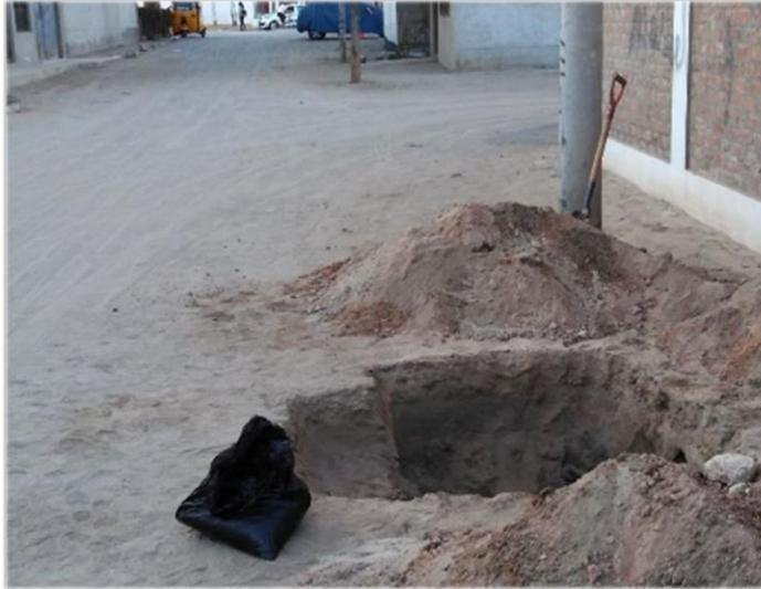
**Fig.10.** *Obtención de la muestra in situ por cada lente estratigráfico observado.*
