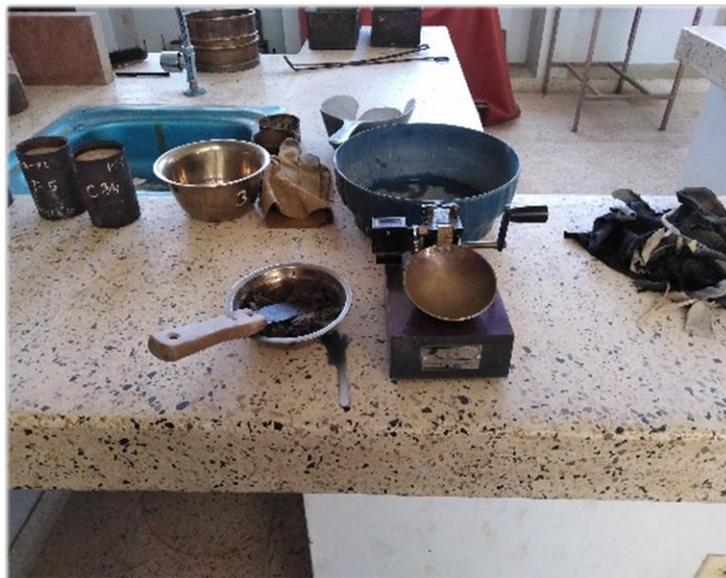
**Fig.14.** Muestra de los materiales para el cálculo de los límites de consistencia del suelo
