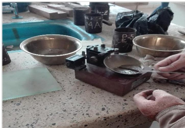
**Fig.15.** Uso del instrumento "Casagrande" para limite liquido
