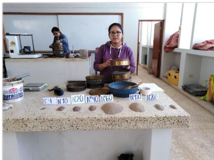
**Fig.13.** Muestra del resultado final de peso retenido de cada tamiz
