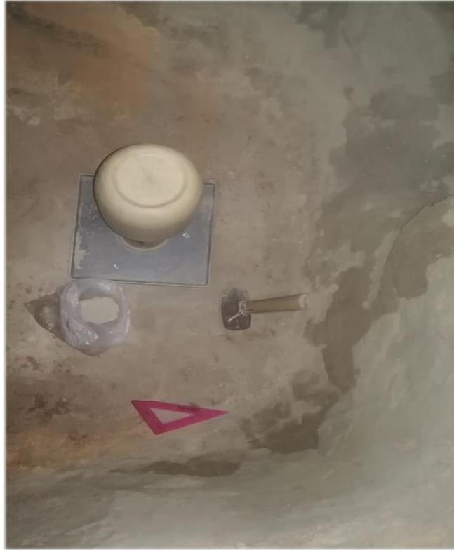
**Fig.16.** Realizando el ensayo densidad de campo, mediante el cono de arena.
