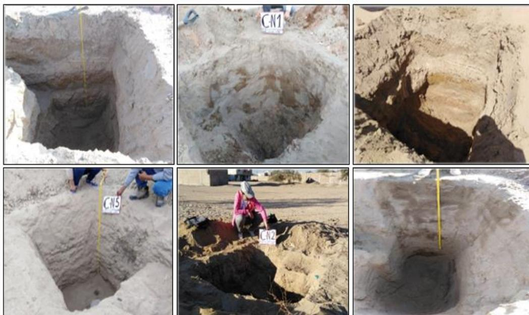
**Fig.9.** Vista del interior de los pozos exploratorios e identificación de calicatas
