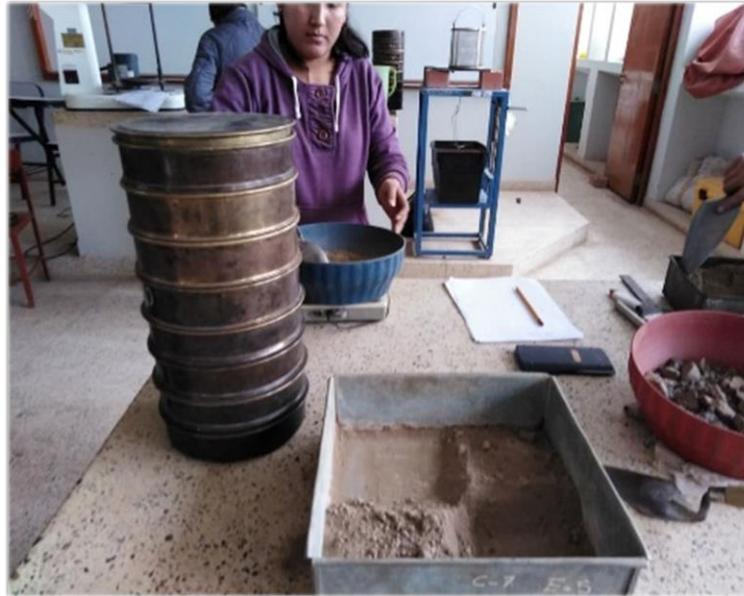
**Fig.12.** Cuarteo de la muestra para su posterior tamizado
