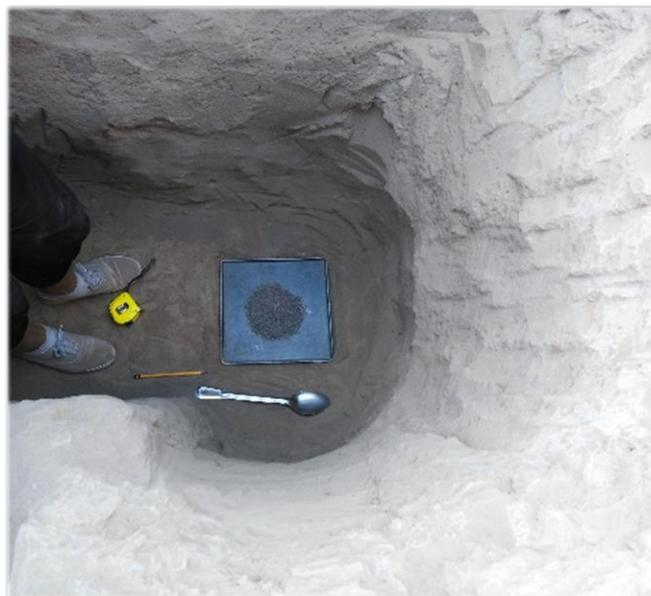
**Fig.17.** Culminando ensayo de densidad de campo.
