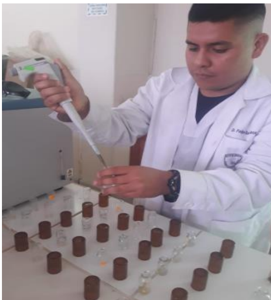
Figura 46. Mezcla y enrasado de la muestra con el reactivo Folin Ciocalteu (100 g de ácido fosfotúngstico y 25 g ácido fosfomolibdico en H_2O_2 )
