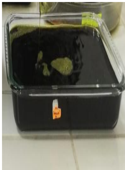
Figura 17. Secado del extracto etanólico e hidroalcohólico a temperatura ambiente para la evaporación del solvente.
