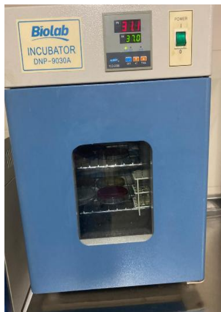
Figura 47. Incubación de los cultivos microbianos en estufa a temperatura controlada de 35–37 °C.
