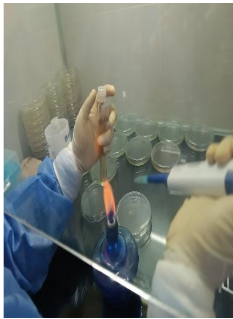
Figura 51. Apertura del frasco con la cepa microbiana dentro de la campana de flujo laminar para garantizar condiciones estériles.
