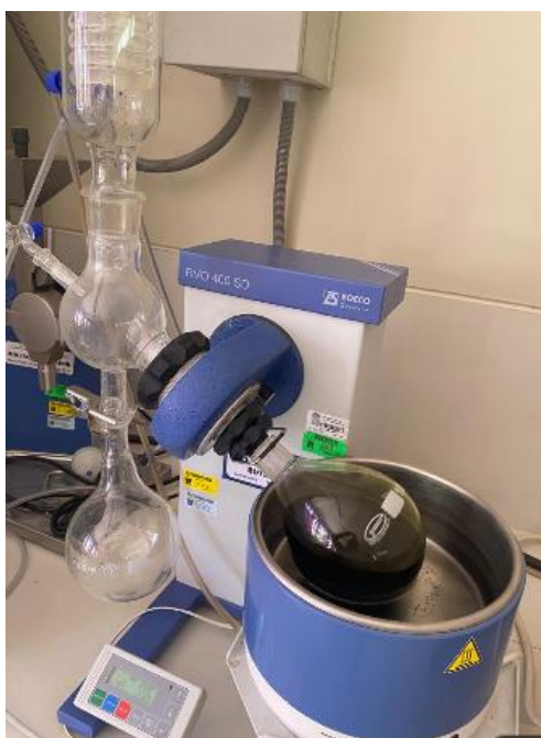
Figura 18. Transferencia del extracto metanólico filtrado a balón de evaporación para su concentración.
