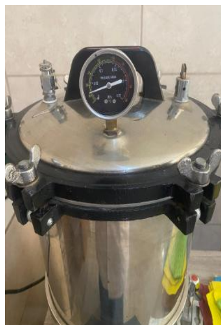
Figura 41. Esterilización de los medios de cultivo en autoclave a 121 °C y 15 lb de presión.
