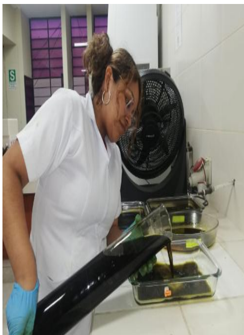
Figura 16. Colocación del extracto etanólico e hidroalcohólico filtrado en bandeja para su concentración.
