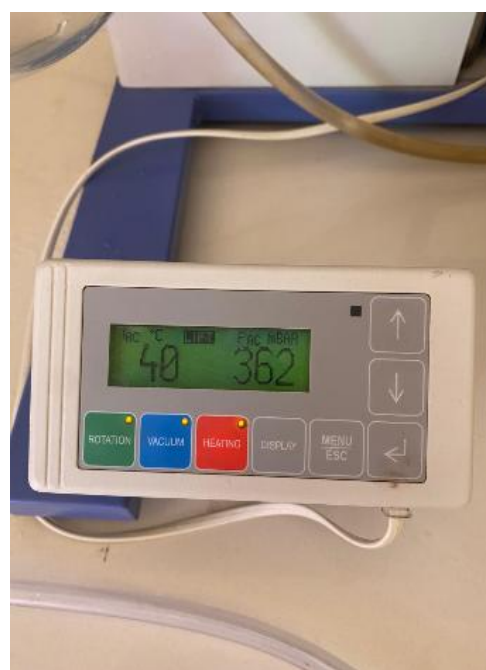
Figura 19. Ajuste de la temperatura a 40 °C y presión al vacío aproximada de 360 mbar.
