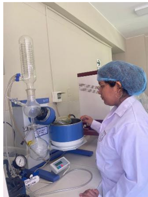
Figura 21. Concentración progresiva del extracto metanólico mediante evaporación controlada del solvente.
