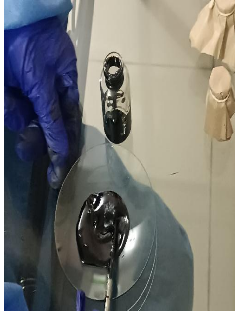
Figura 43. Resuspensión del extracto en los solventes correspondientes para la obtención de concentraciones al 100 %, 75 %, 50 % y 25 %.
