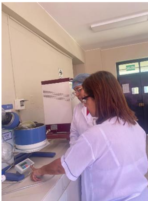
Figura 20. Inicio del proceso de evaporación del solvente metanólico bajo presión reducida.
