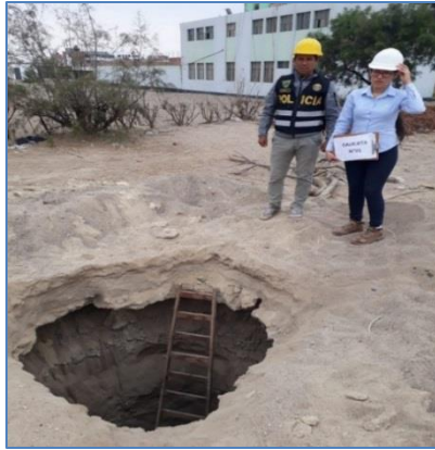
Fotografía. Vista de la excavación realizada en la calicata para la extracción de las muestras.
