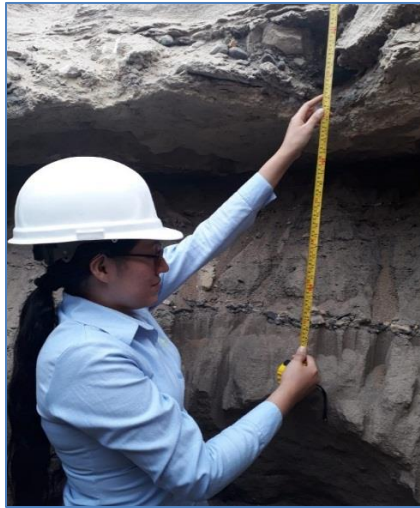
Fotografía. Vista de la excavación realizada en la calicata para la extracción de las muestras.
