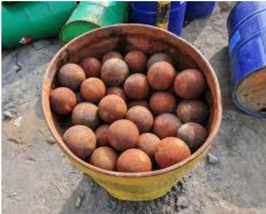
Fig. 23. Bolas de Molino con corrosion intensiva (Fuente: Fueyo)
