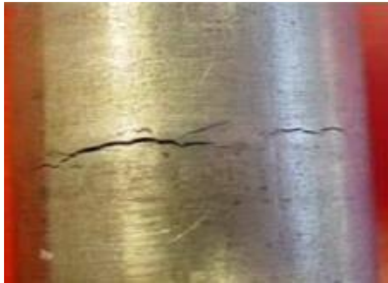
Fig. 18. Corrosión por agrietamiento. (Fuente Brasunas, A.)
