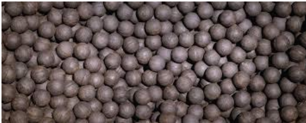
Fig. 22. Bolas corroídas de Molino de minerales (Fuente: Fueyo)
