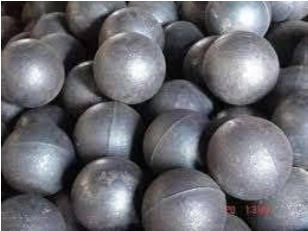
Fig. 21. Bolas nuevas de molino de minerales (Fuente: Fueyo)
