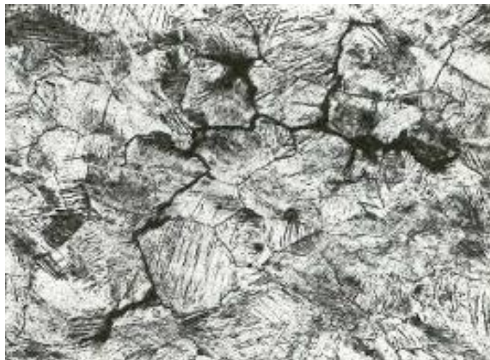
Fig. 15. Corrosión intragranular (Fuente: Brasunas, A.)
