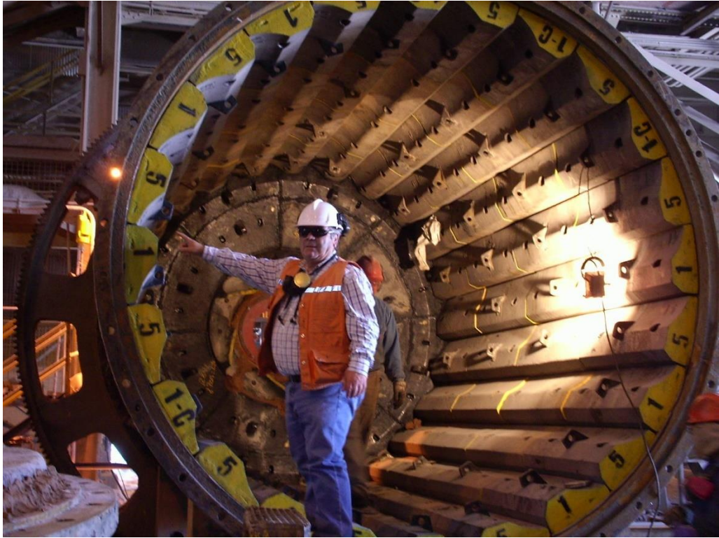
Fig.5. Molino de bolas con blindajes tipo cascada. (Fuente: Empresa Fundición Metal Norte – Chile)
