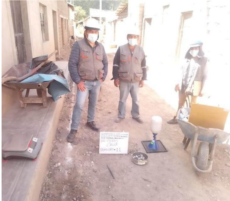
Fotografía 12. Prueba de Densidad de la Subrazante
