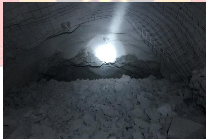
Figura 12. Resultados de malla XC 10362 SE 3.5m x 3.0m
