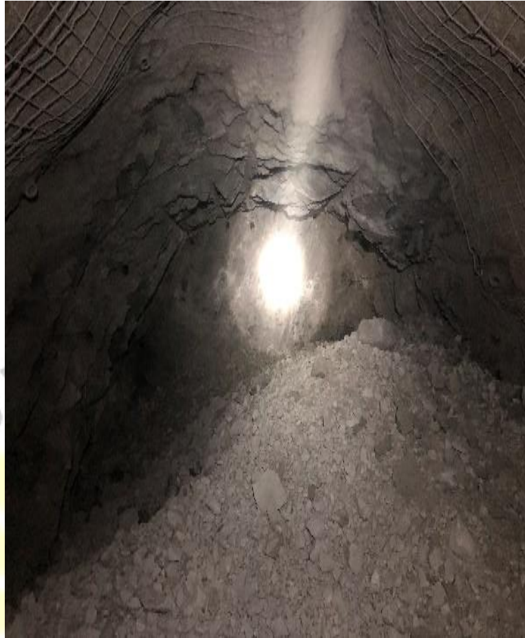
Figura 6. Resultados de voladura GL10445S 2.4x2.7 – 10.1 pies
