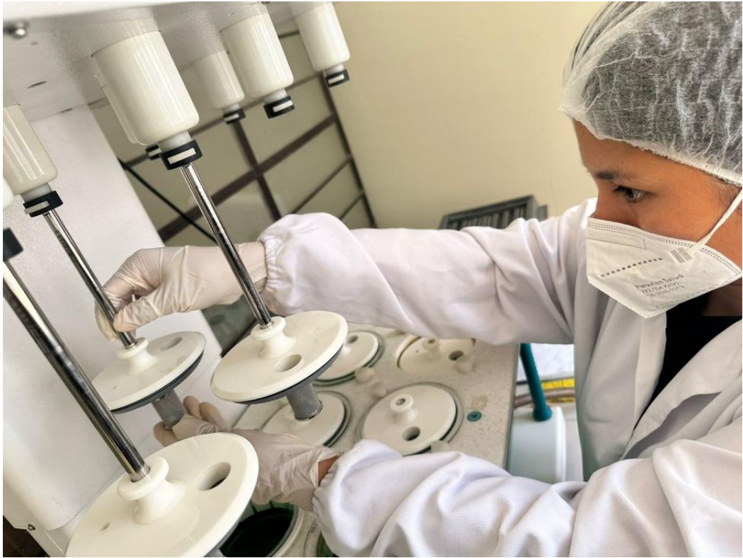
Figura 18. Colocación de las canastillas en el equipo disolutor.
