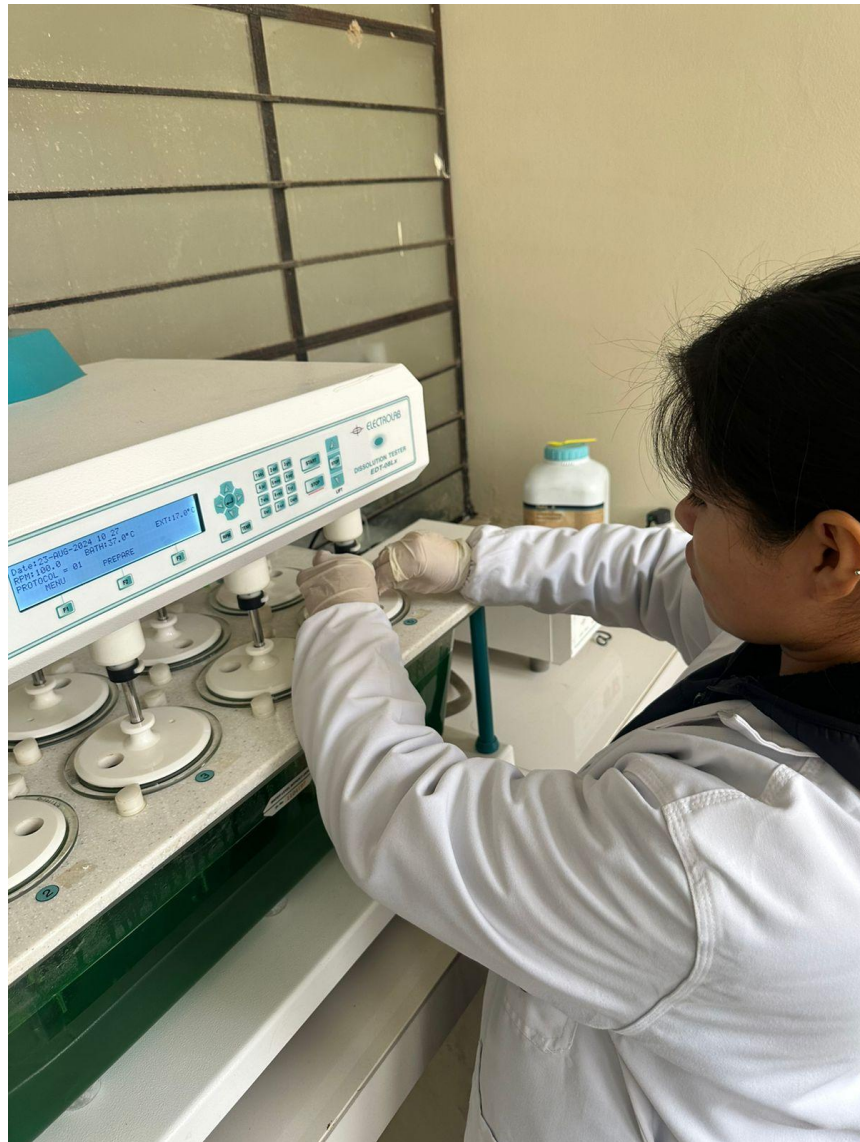
Figura 15. Agregado de los comprimidos al medio de disolución.
