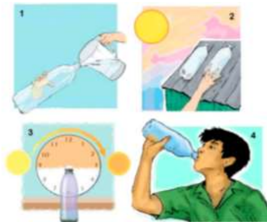
Figura 1 Una descripción gráfica de la técnica de tratamiento de agua doméstica de desinfección solar (SODIS)
