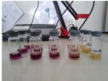
Figura 17. Cambio de coloración debido a la reducción del radical libre DPPH.
