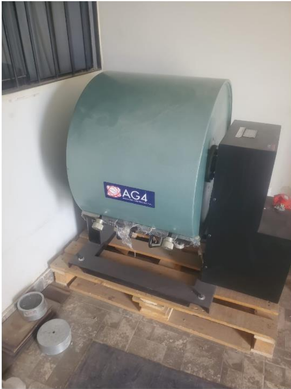
Figura. 54 Ensayos de laboratorio, Abrasión con Máquina de los Ángeles
