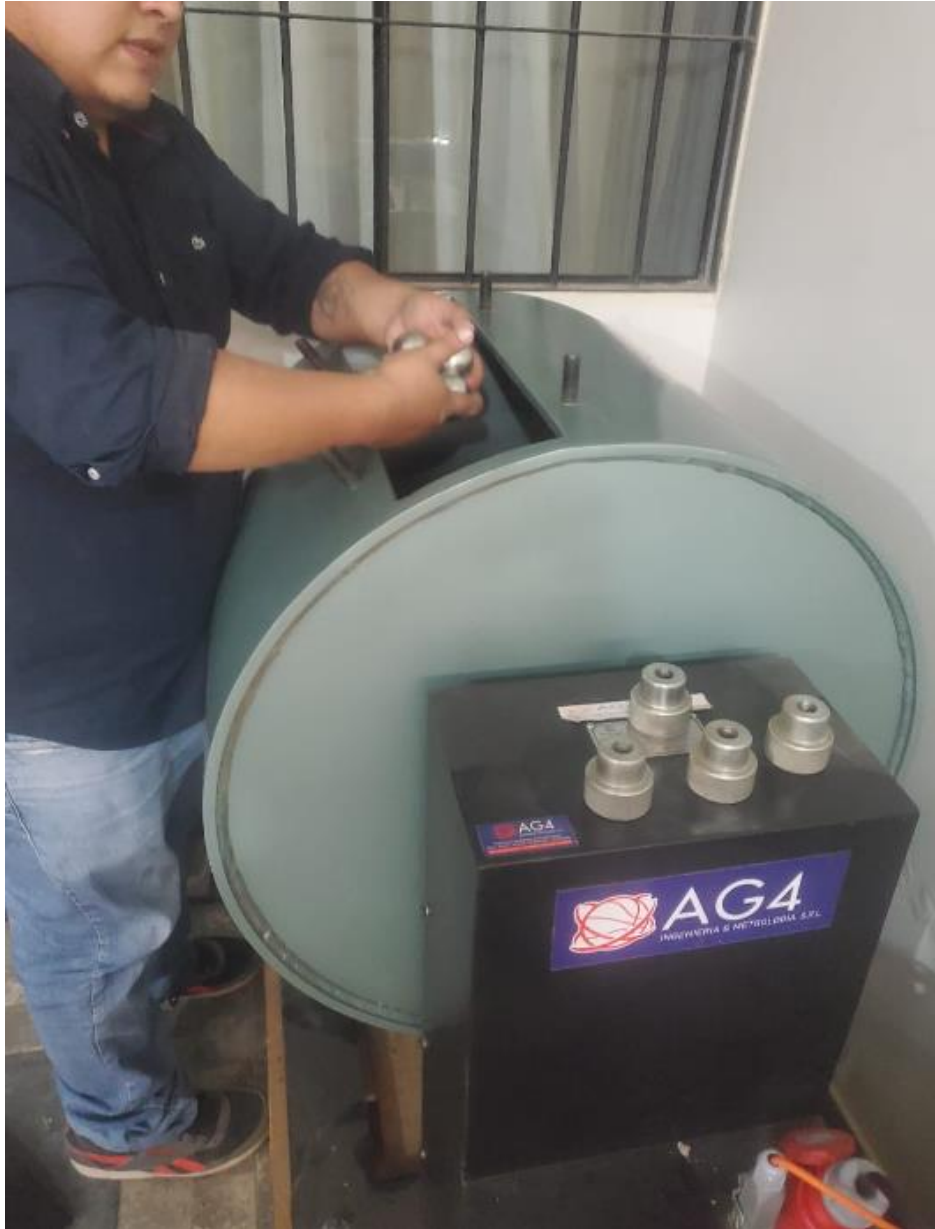
Figura. 63 Ensayos de laboratorio, Abrasión con Máquina de los Ángeles
