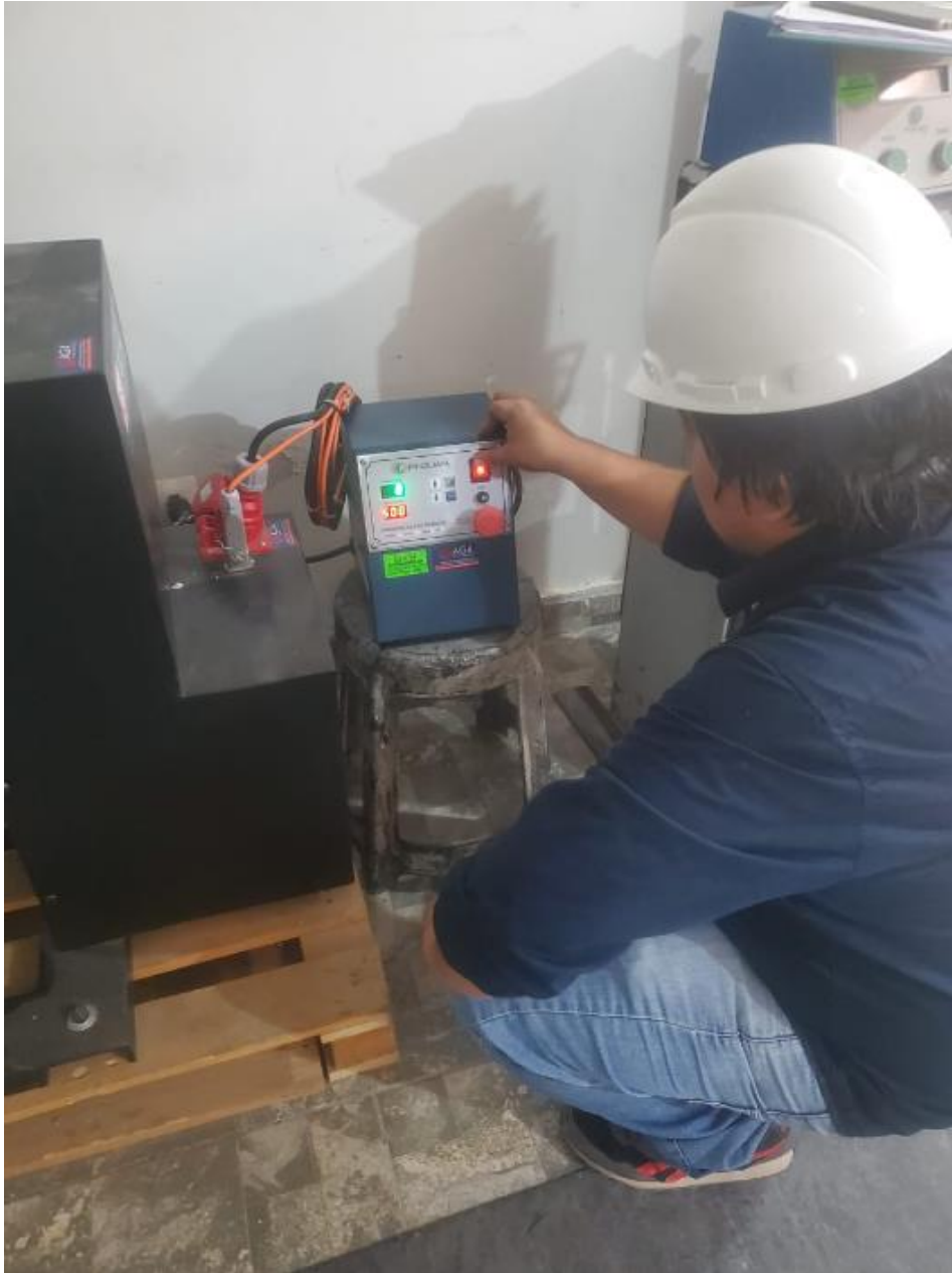
Figura. 64 Ensayos de laboratorio, Abrasión con Máquina de los Ángeles
