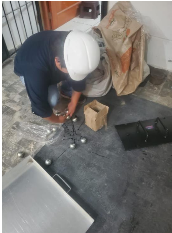
Figura. 62 Ensayos de laboratorio, Abrasión con Máquina de los Ángeles
