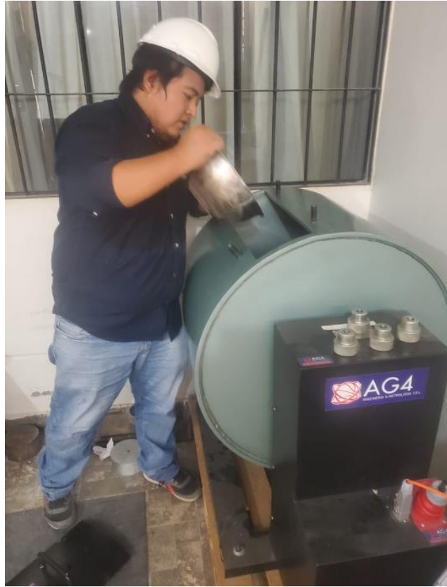
Figura. 61 Ensayos de laboratorio, Abrasión con Máquina de los Ángeles
