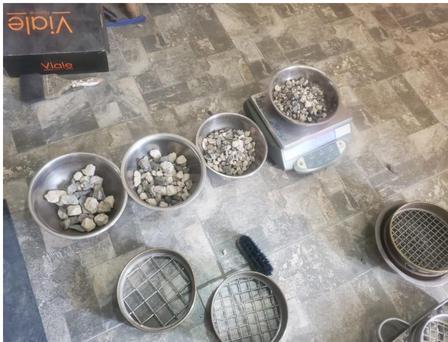
Figura. 60 Ensayos de laboratorio, Abrasión con Máquina de los Ángeles
