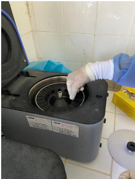
Figura 11: Colocación de capilares en la centrifuga
