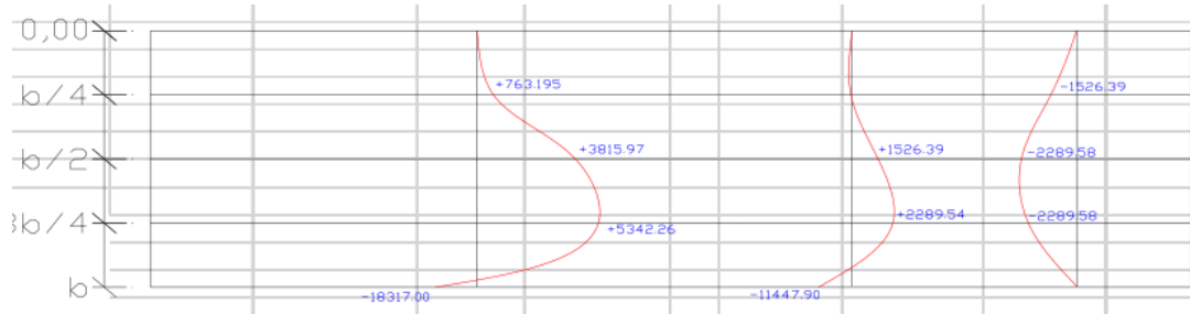
Figura 62 Diagrama de momentos verticales
