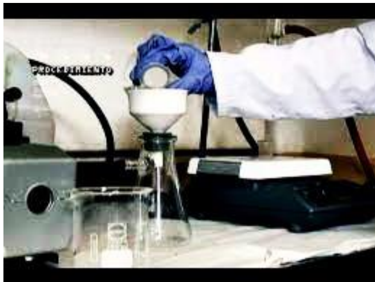
Fig. 15. Filtración de la muestra atacada con ácido [5]
