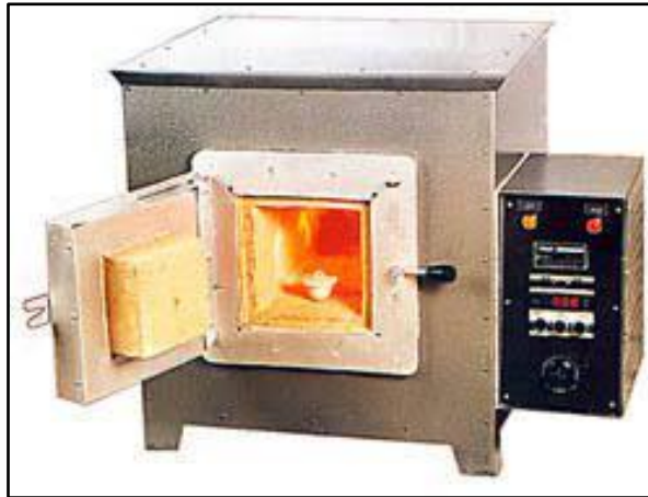
Fig. 11. Determinación de cenizas en mufla eléctrica [6]
