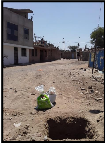
Fig. N° 12 Exploración de Calicata N°01
