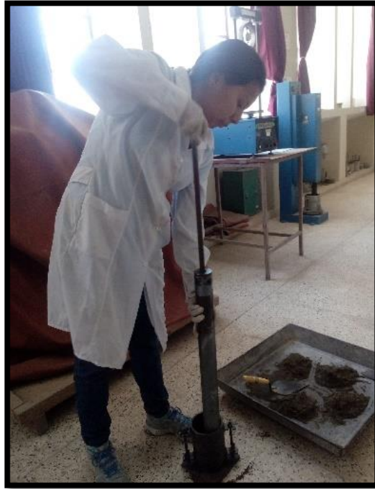
Fig. N° 23 Proceso de Compactado
