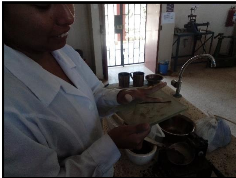
Fig. N° 19 Proceso Límite Plástico
