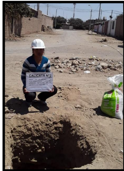
Fig. N° 13 Exploración de Calicata N°02
