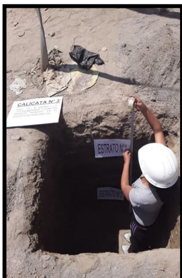
Fig. N° 09 Exploración de Calicata N°03
