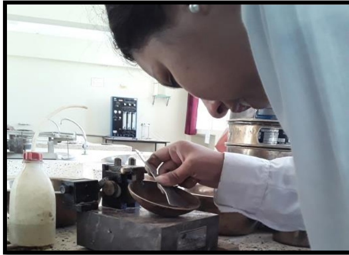
Fig. N° 18 Proceso Límite líquido
