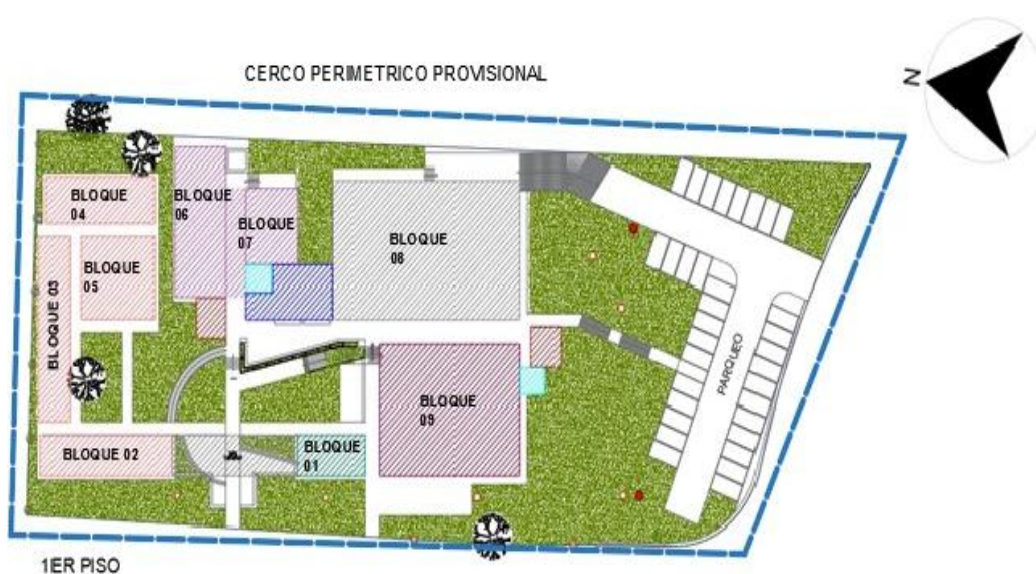
Figura 5: Delimitación del cerco de obra
