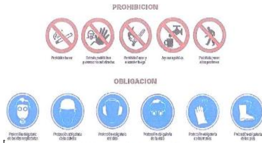
Figura 31: Algunas señalizaciones en obra que son obligatorias
