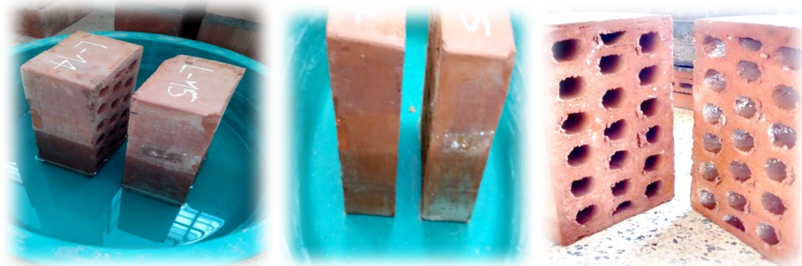
Fig. 14: Ensayo de eflorescencia de las unidades de arcilla cocida
