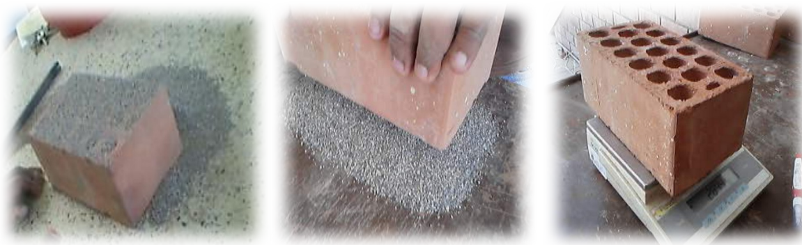
Fig. 13. Llenado de arena calibrada de los 18 huecos y el pesado de la unidad de arcilla para el ensayo de densidad.
