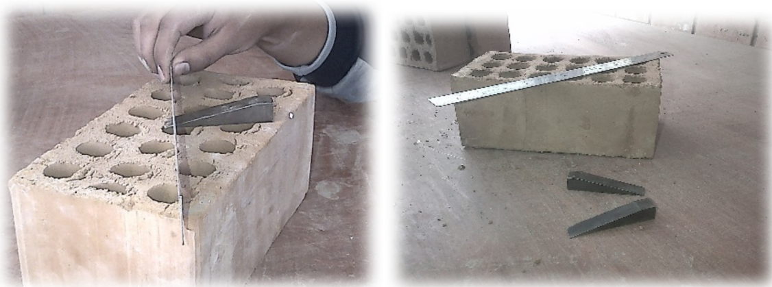
Figura 5. Medida del alabeo de las unidades de albañilería
