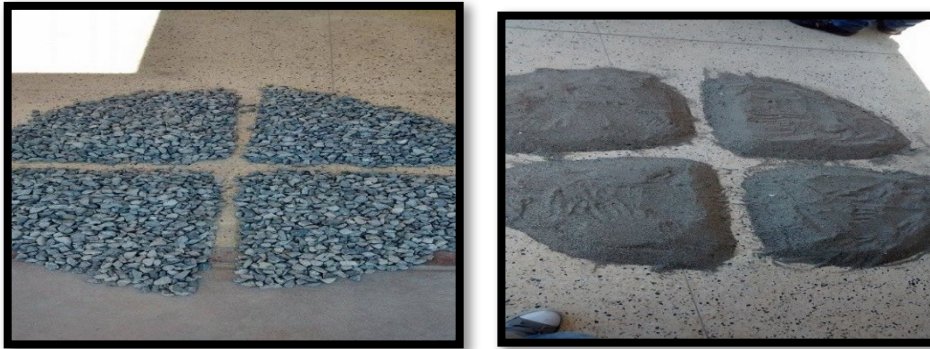
Fig. 16 y Fig. 17. Selección de muestra de agregados por el método del cuarteo
