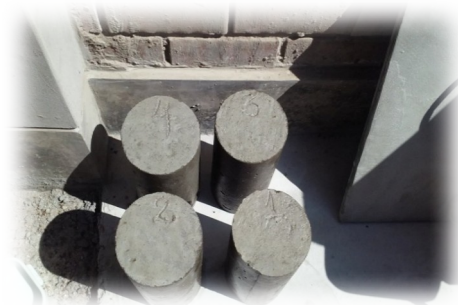
Fig. 20. Corresponden a las probetas después de sacarse de los moldes
