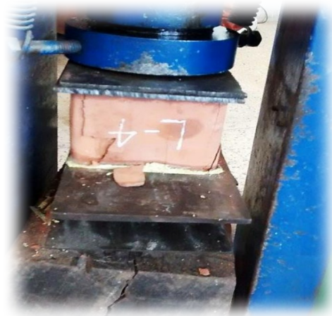
Fig. 6 y Fig. 7 Ensayo de resistencia del ladrillo de arcilla cocida
