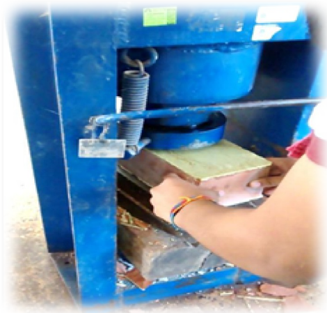
Fig. 6 y Fig. 7 Ensayo de resistencia del ladrillo de arcilla cocida
