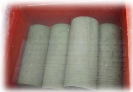
Fig. 21. Se muestran las probetas en la poza con agua en el proceso de curado
