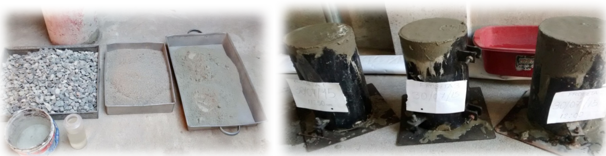
Fig.18. Se muestran los componentes que se utilizaron para preparar la mezcla de concreto Fig.19. Corresponde a probetas recién llenadas de la muestra de concreto.
