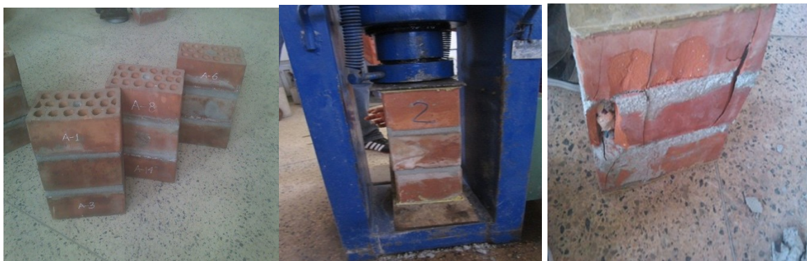
Fig.10: Ensayos de resistencia de prismas de unidades de arcilla en el laboratorio
