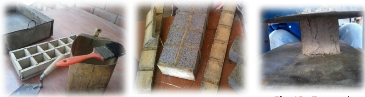
Fig. 15: Ensayo de resistencia a la compresión del mortero
