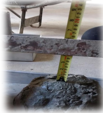
Fig. 22 y Fig. 23. Corresponden al ensayo del cono de Abrams y el resultado obtenido de su asentamiento.
