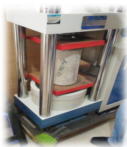
Fig. 24 y Fig. 55. Se aprecia el ensayo de resistencia en probetas cilíndricas en el laboratorio
