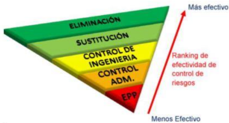
Figura 22 Controles de riesgo
