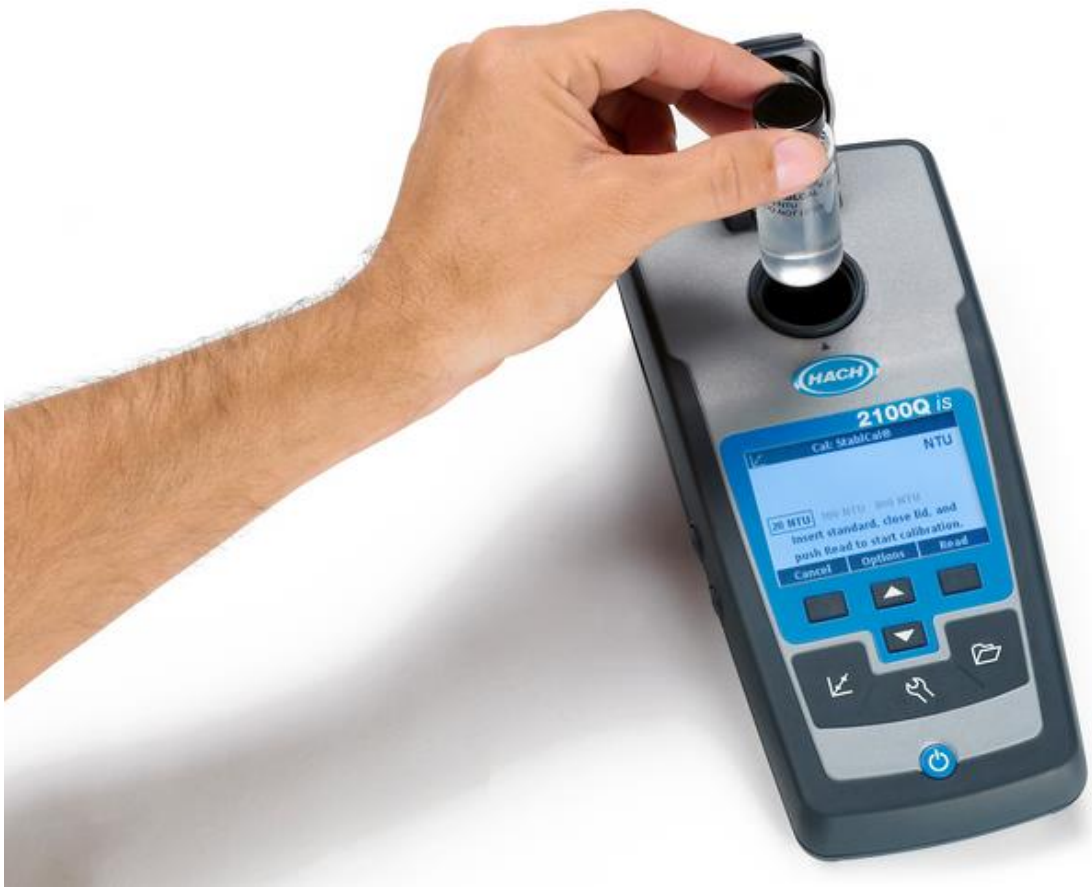
Foto 11 Turbidimetro de HACH 2100Q
