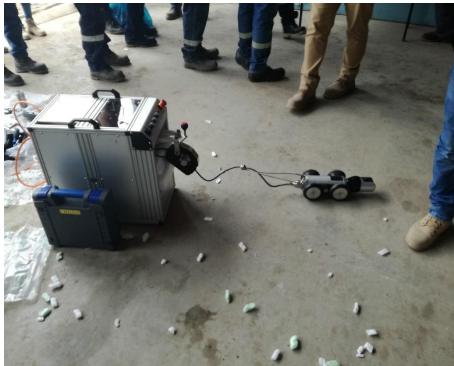
Figura. 35: Cámara televisa de inspección de red de alcantarillado y agua
