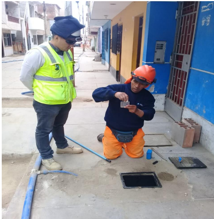
Figura. 11: Prueba de desinfección de agua potable Fuente: Elaboración Propia
