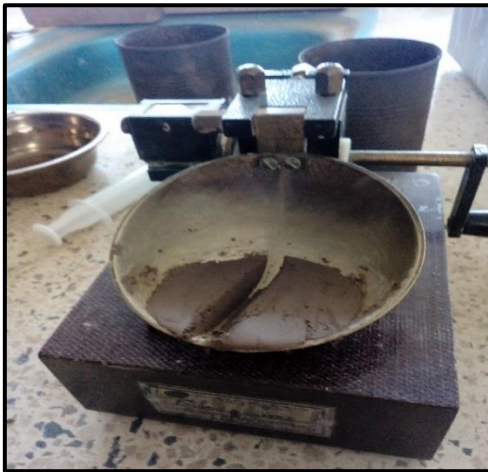
Prueba de límite líquido, plástico y resistencia. Campana de Casagrande
