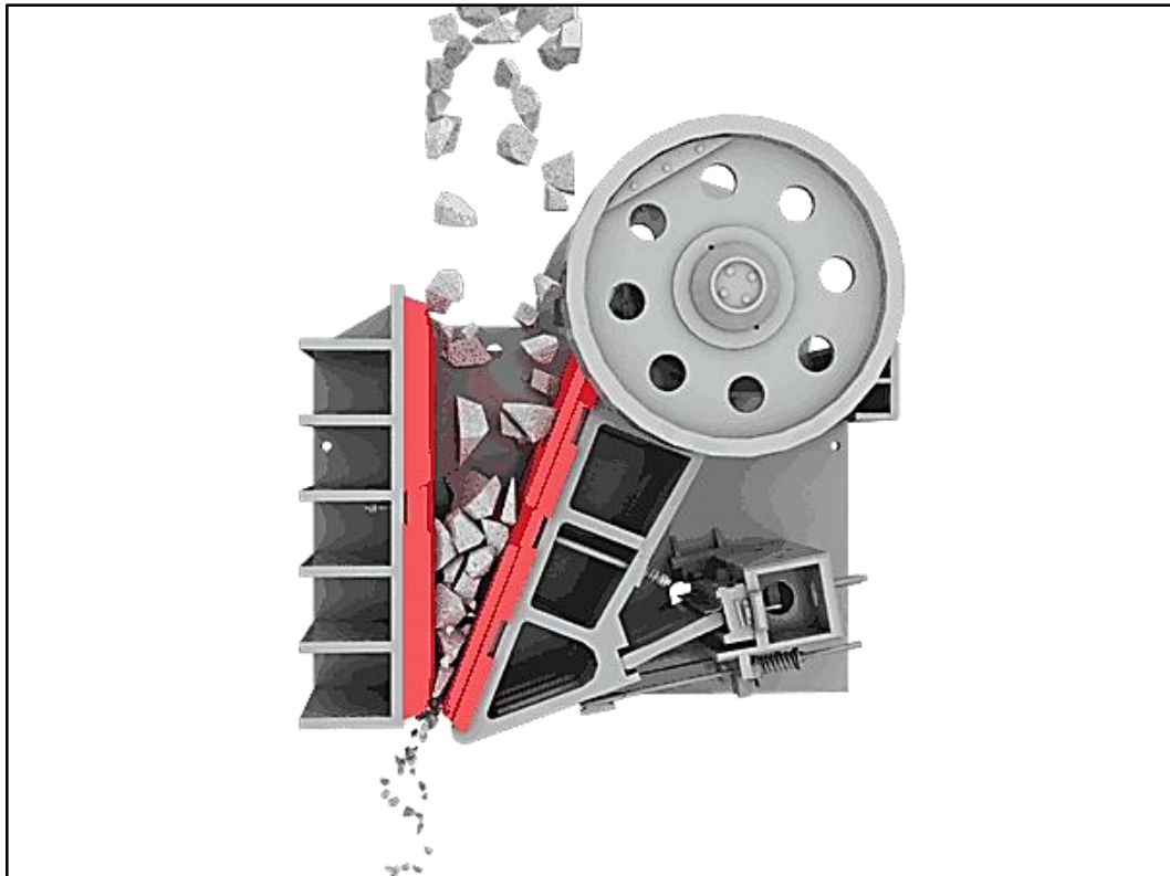
Fig. 2.2. Tratamiento físico del mineral. Chancado en chancadora de quijadas.
