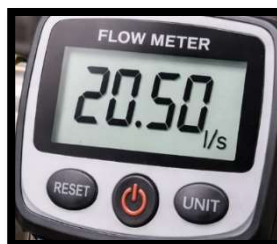
Figura No 29: medición del caudal del agua permeada, el cual es un valor óptimo de producción y de una buena eficiencia del sistema.
