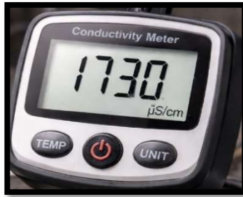
Figura No 11: medición de la conductividad del agua tratada, el cual es un valor no adecuado que estuvo fuera de rango normativo.
