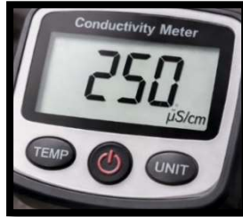
Figura No 26: medición de la conductividad del agua tratada, el cual es un valor adecuado y que cumple con el rango normativo.
