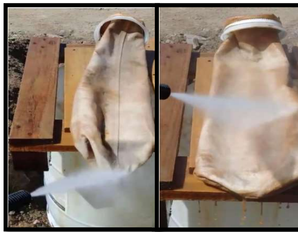
Figura No 18: Se realizo la limpieza de los filtros usados y/o saturados ya sean de bolsa o cartucho para volver a reutilizarse a fin de poder generar ahorro en los consumibles del sistema.
