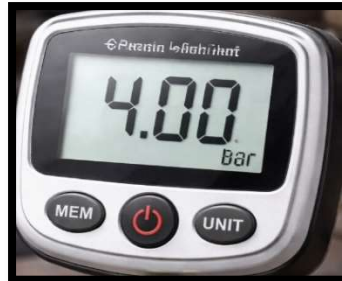
Figura No 13: medición de la diferencia de presión en las membranas de Osmosis Inversa, el cual es un valor muy elevado debido a la saturación de las membranas del sistema.
