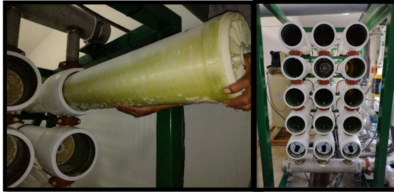
Figura No 8: Membranas saturadas de Caliche
