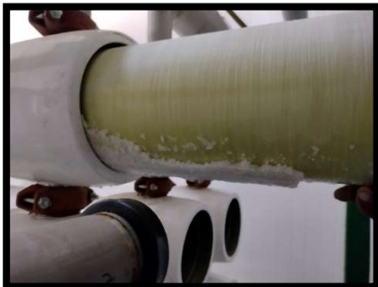
Figura No 5: Membranas saturadas de Caliche
