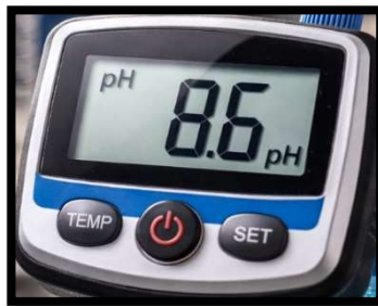
Figura No 12: medición del pH del agua tratada, el cual es un valor no adecuado que estuvo fuera de rango normativo.
