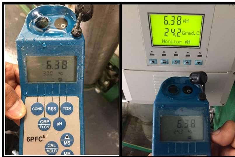
Figura No 19: Se realizo la calibración de los sensores de medición de PH y se contrasto con el medidor portátil y el HMI del sistema.
