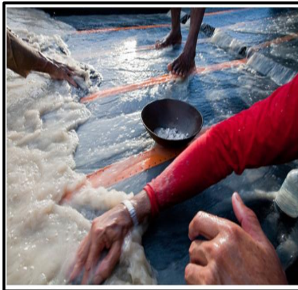
Figura 3 Amalgamación del oro
