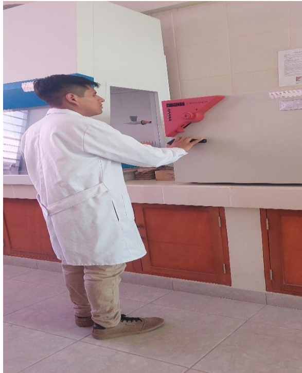
Figura 21. Secado de la muestra en el horno para la determinación humedad.
