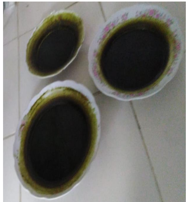
Figura 32. Secado a temperatura ambiente del extracto obtenido por ultrasonido
